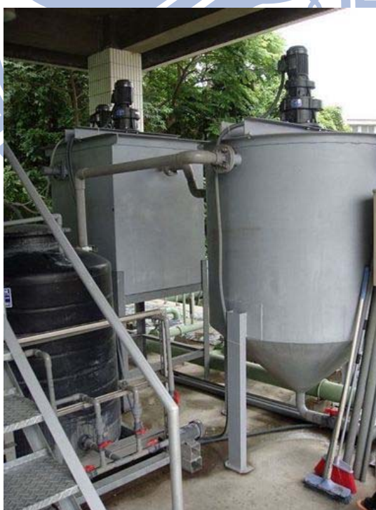
圖 3.7 MBR 模型廠前處理設備
