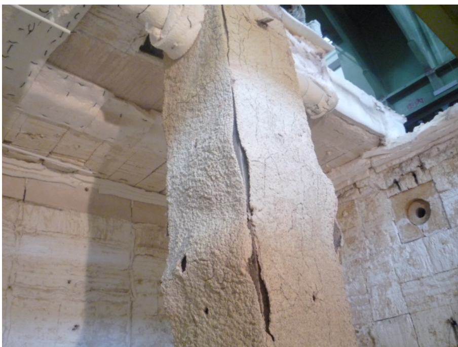
圖 4-28 試體 CFBC-2 上段試驗後防火被覆開裂
