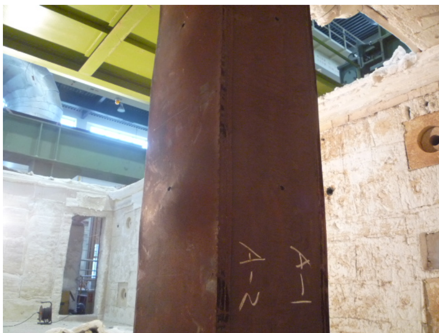
圖 4-47 試體 CFBC-3 中段局部挫屈情形
