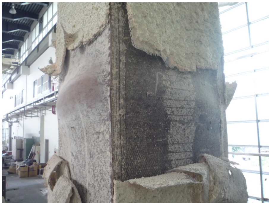
圖 4-31 試體 CFBC-2 中段試驗後局部挫屈(已剝除防火被覆及鋼網) (資料來源：本研究整理)
