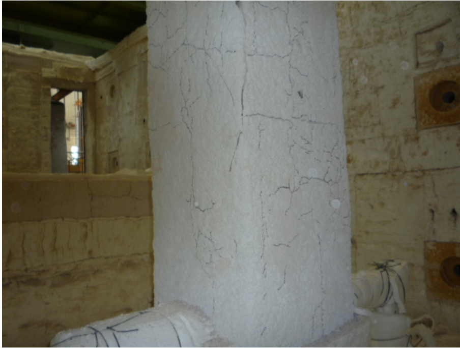
圖 4-15 試體 CFBC-1 下段試驗後防火被覆裂縫
