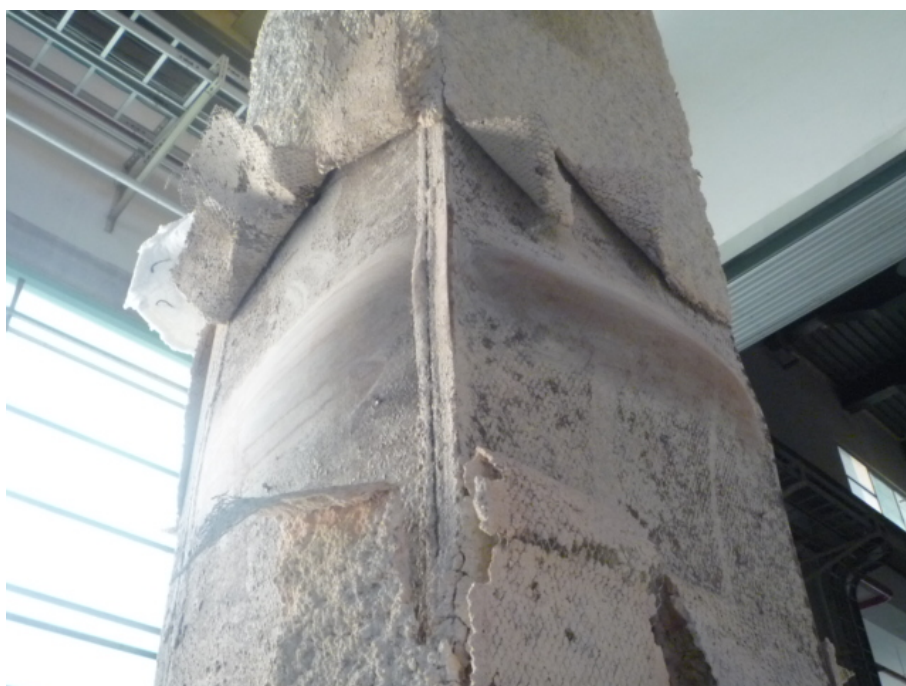
圖 4-32 試體 CFBC-2 中段試驗後局部挫屈(已剝除防火被覆及鋼網) (資料來源：本研究整理)
