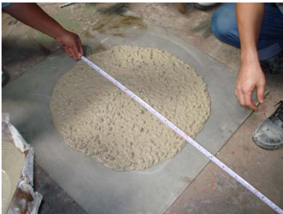
圖 3-5 自充填凝土於灌漿前進行坍流度之量測
