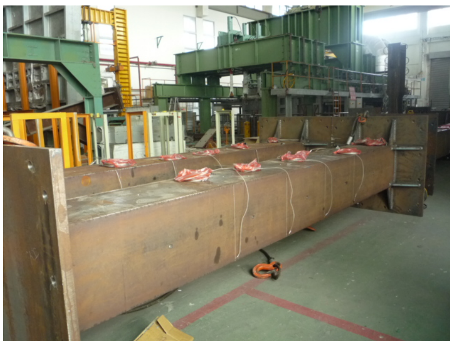
圖 3-6 CFBC 試體表面熱電偶測點安裝圖
