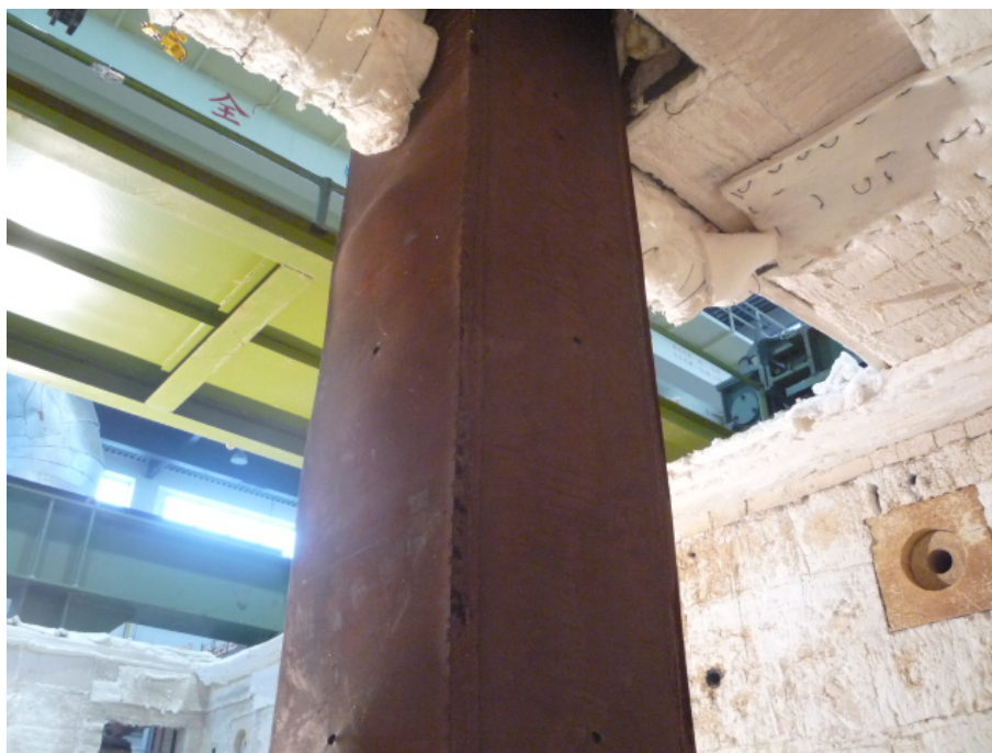
圖 4-46 試體 CFBC-3 上段局部挫屈情形
