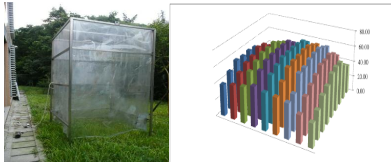
圖 4 (a) 降雨模擬器；(b) 模擬均勻度
