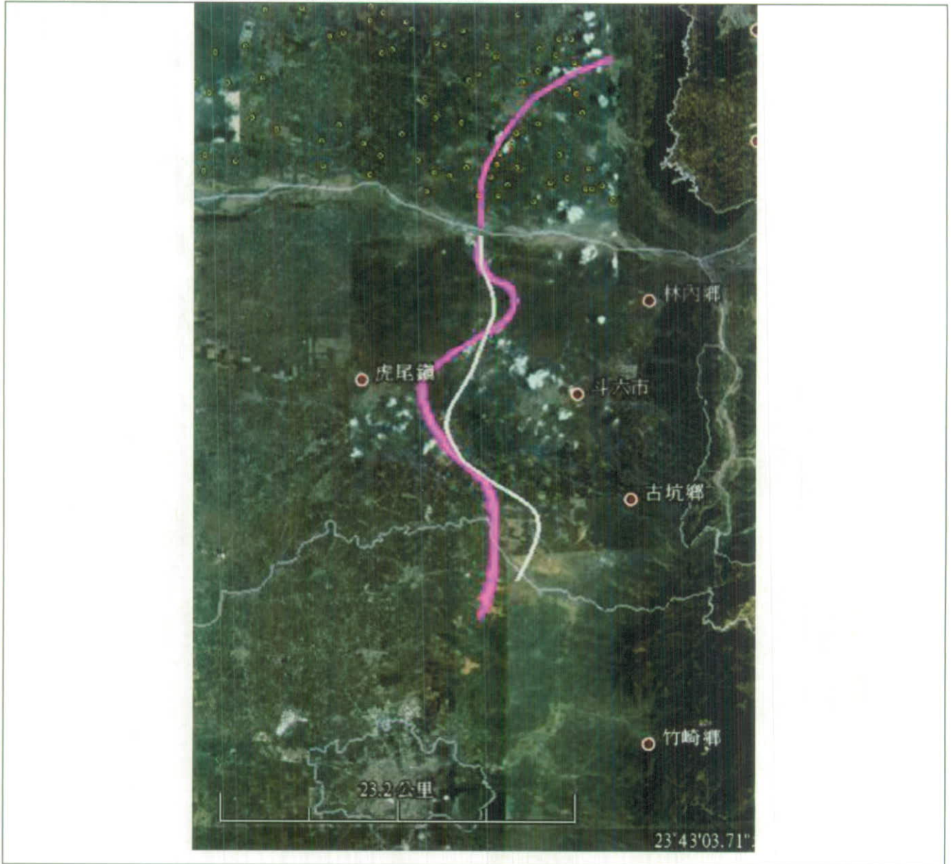
圖 6.1-72 濁水溪沖積扇由地電阻測深法及觀測井資料所推測之補注區界限(白色實線)，以及由二維地電阻反演影像剖面方法研判之補注區界限帶(桃紅色區域)。
