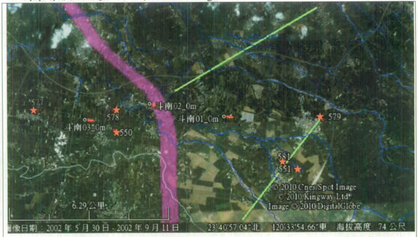
圖 6.1-67 斗南區測線與一維 Schlumberger 地電阻測點位置關係圖。星號為一維 Schlumberger 地電阻測點。補注區邊界判定落在斗南-02 測線上，且補注區邊界西側亦有由東向西依次 No.550、578、577 之一維 Schlumberger 測點。斗南-03 測線剛好位於這三個一維 Schlumberger 測點之間。
