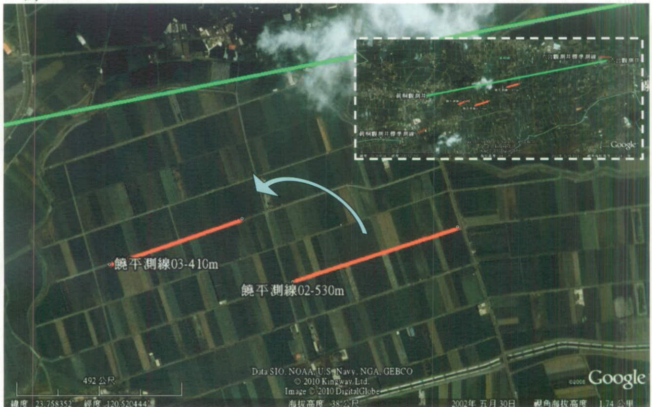
圖 6.1-21 荊桐-03 測線佈設位置圖，測線長度 410 米。綠色線為刺桐與六合觀測井連線，白色虛線圖框中紅色虛線框表示此區相對刺桐區測線的位置。
