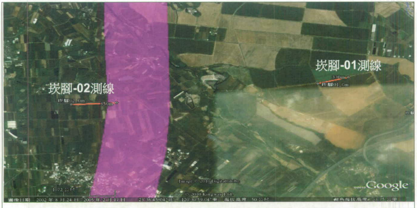
圖 6.1-53 崁腳區測線補注邊界過渡帶判斷為崁腳-01 測線與崁腳-02 測線
