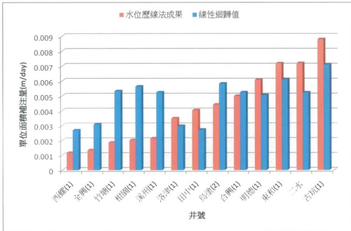
圖 4.4-5 濁水溪沖積扇非拘限站井單位面積補注量(1998 年至 2003 年與 2006 年至 2009 年水位歷線法成果與多變量線性迴歸值)
