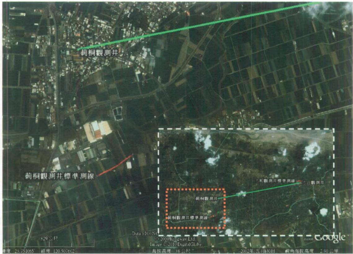
圖 6.1-12 為荊桐觀測井標準測線之佈設位置圖，施測方式選用 Dipole-dipole 方法。綠色線為荊桐與六合觀測井連線，白色虛線圖框中紅色虛線框表示此區相對荊桐區測線的位置。
