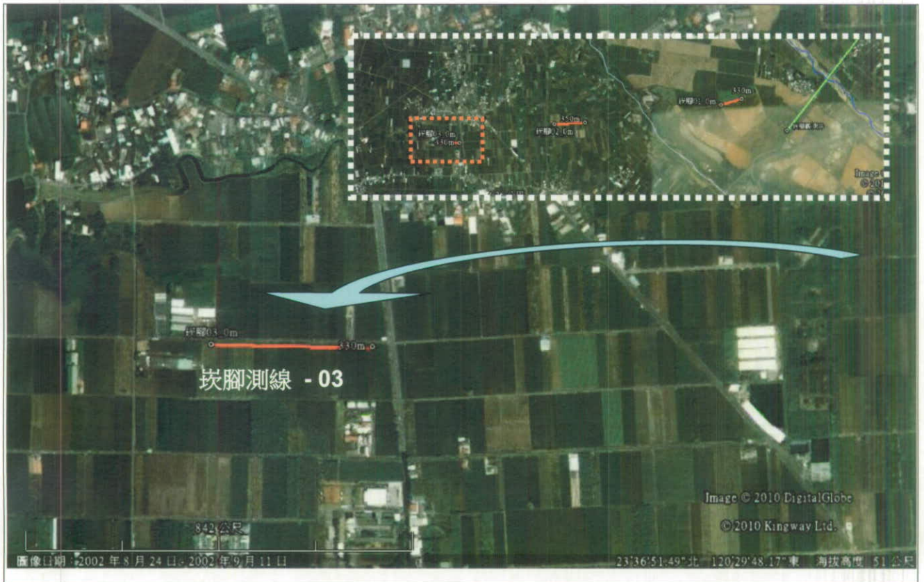
圖 6.1-51 炭腳-03 測線（炭腳區測線）分布圖，測線長度 330 m。綠色線為古坑-炭腳觀測井連線，白色虛線圖框中紅色虛線框框表示此區相對炭腳區測線的位置。
