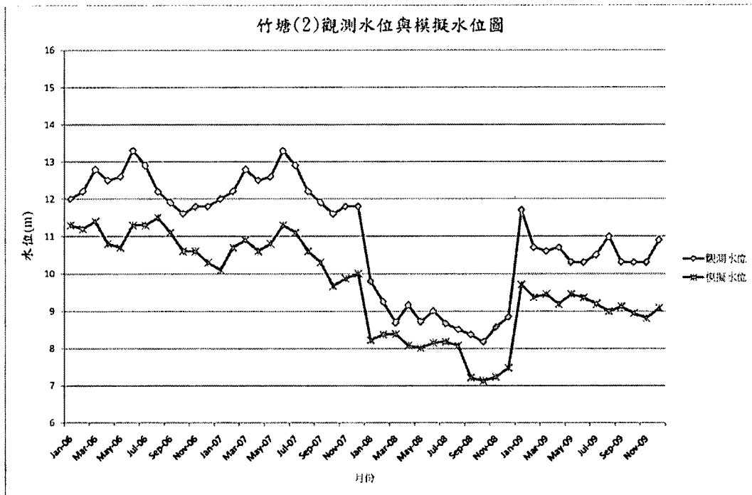
圖 5.5-13 竹塘(2)觀測水位與模擬水位圖(2006 至 2009 年第五層均方根誤差最大之觀測站)
