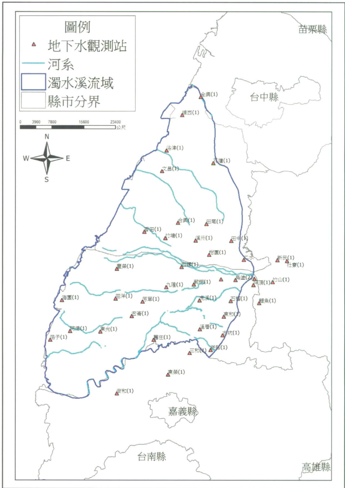
圖 2.2-1、含水層一(F1)42 口地下水觀測井分布圖
