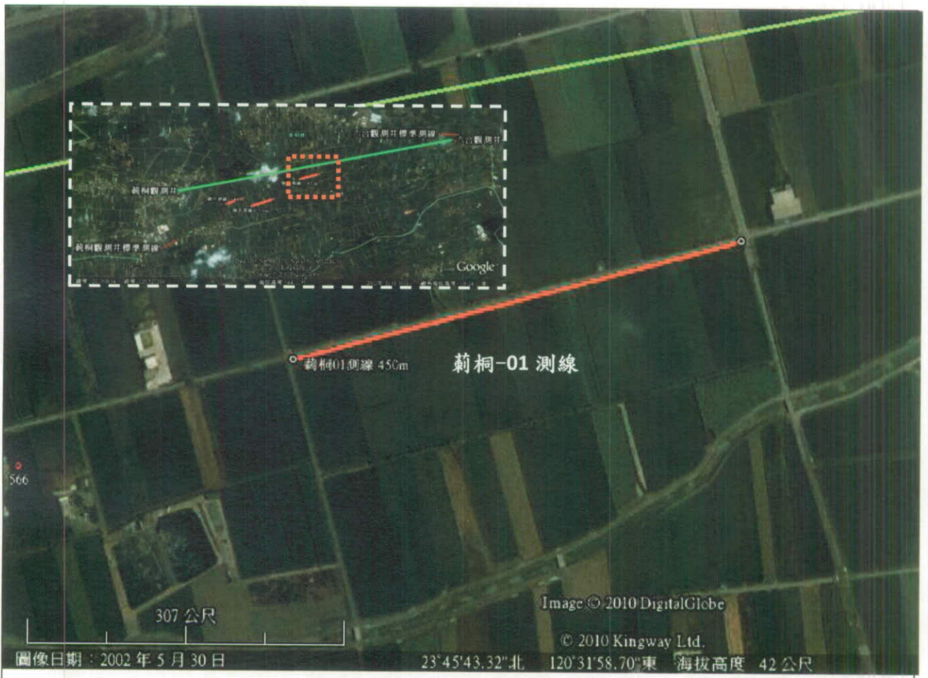
圖 6.1-17 荊桐-01 測線（荊桐區測線）分布圖，測線長度 450 米。綠色線為荊桐與六合觀測井連線，白色虛線圖框中紅色虛線框表示此區相對荊桐區測線的位置。
