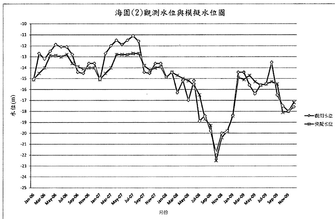
圖 5.5-14 海園(2) 觀測水位與模擬水位圖(2006 至 2009 年第五層均方根誤差中等之觀測站)
