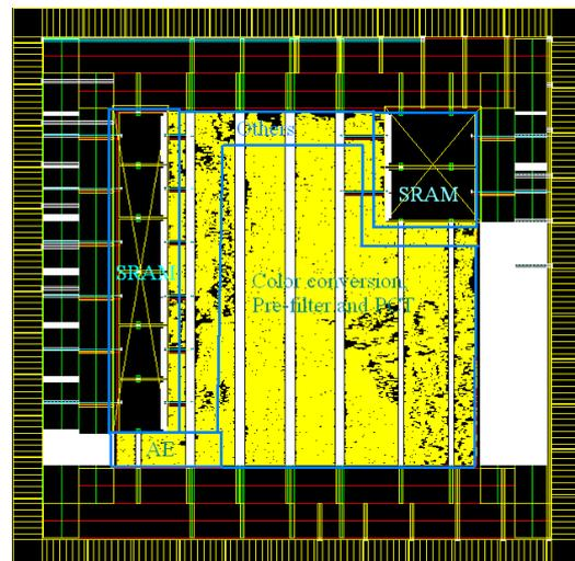
FIG. 21. THE LAYOUT OF JPEG XR ENCODER.
