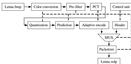
**Fig. 8. JPEG XR Coding Flow.**
