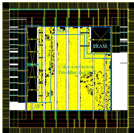
FIG. 21. THE LAYOUT OF JPEG XR ENCODER.
