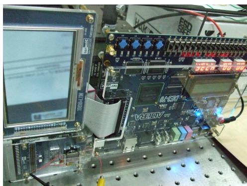
Fig. 1. 影像處理 FPGA 模組
