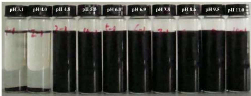
圖 4.1.5.28 pH 值對含有單寧酸的 MWCNT40 穩定度之影響 (Lin et al., 2009)。
