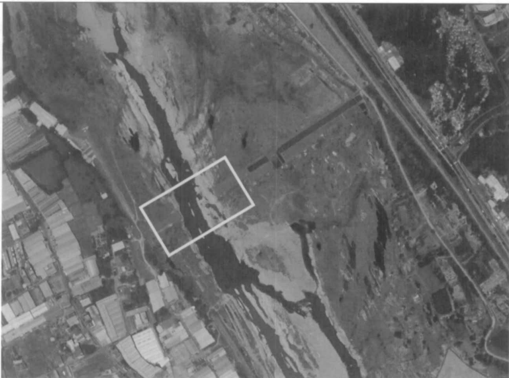
(d) 97.05.17 河道深槽拓寬，岩盤侵蝕範圍擴大。
