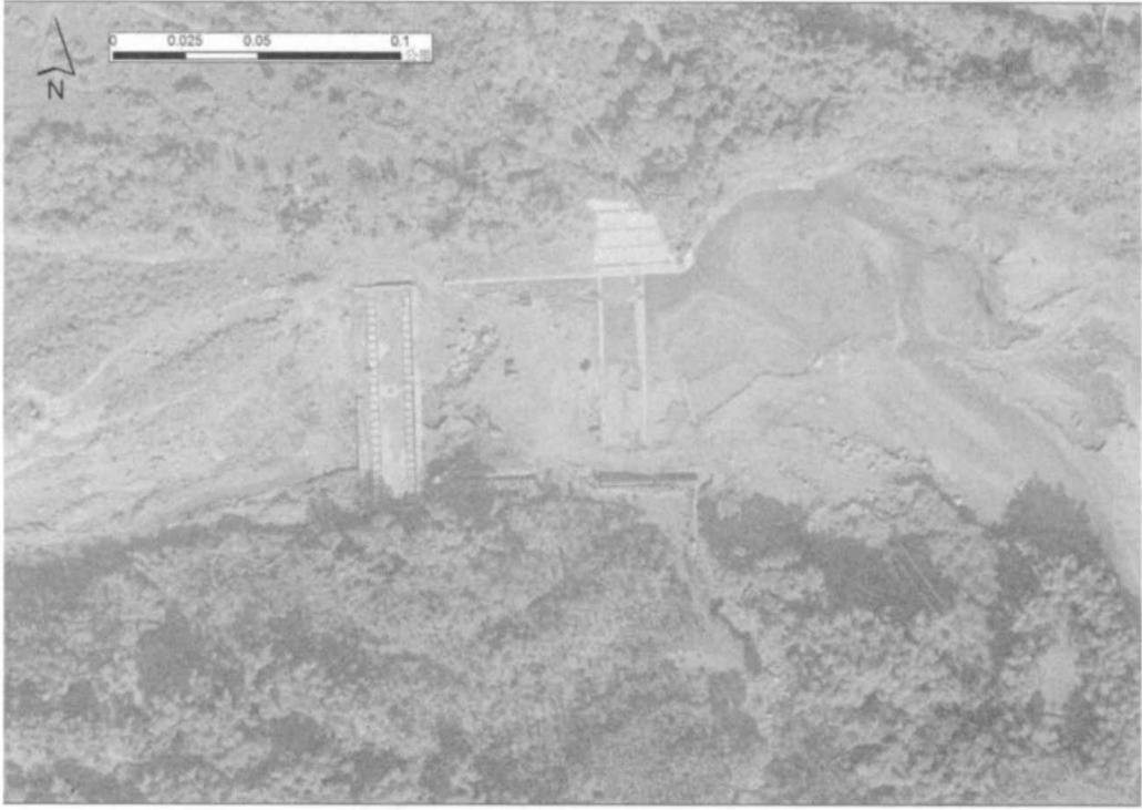
(a) 88.12.24 年 觸口堰興建完成，主要設施包含堰體及下游固床工。
