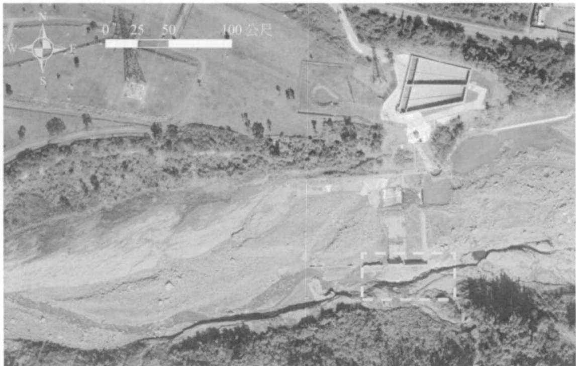
(d) 99.01.10 莫拉克颱風後，堰體左岸沖毀，切穿形成新河道(虛線方框處)。
