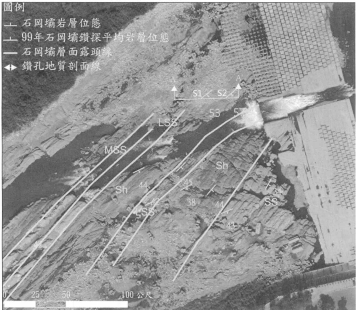
圖 4-15 石岡壩鑽孔平均位態與現地位態
