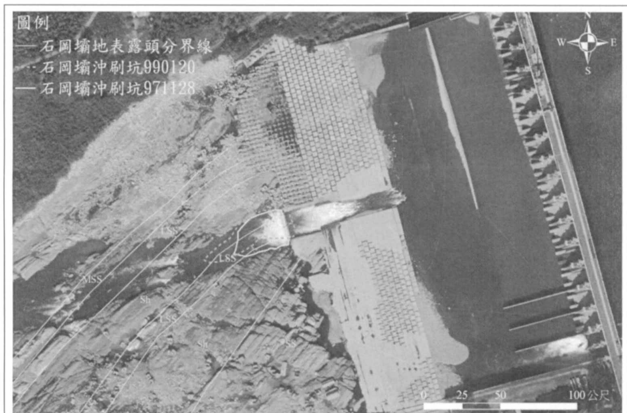
(c) 97.11.28 沖刷坑下游岩盤形成許多平行走向的槽溝，圖中虛線框選處為 99.01.20 現地量測之沖刷坑範圍，為狹長且平行走向的沖刷槽溝。
