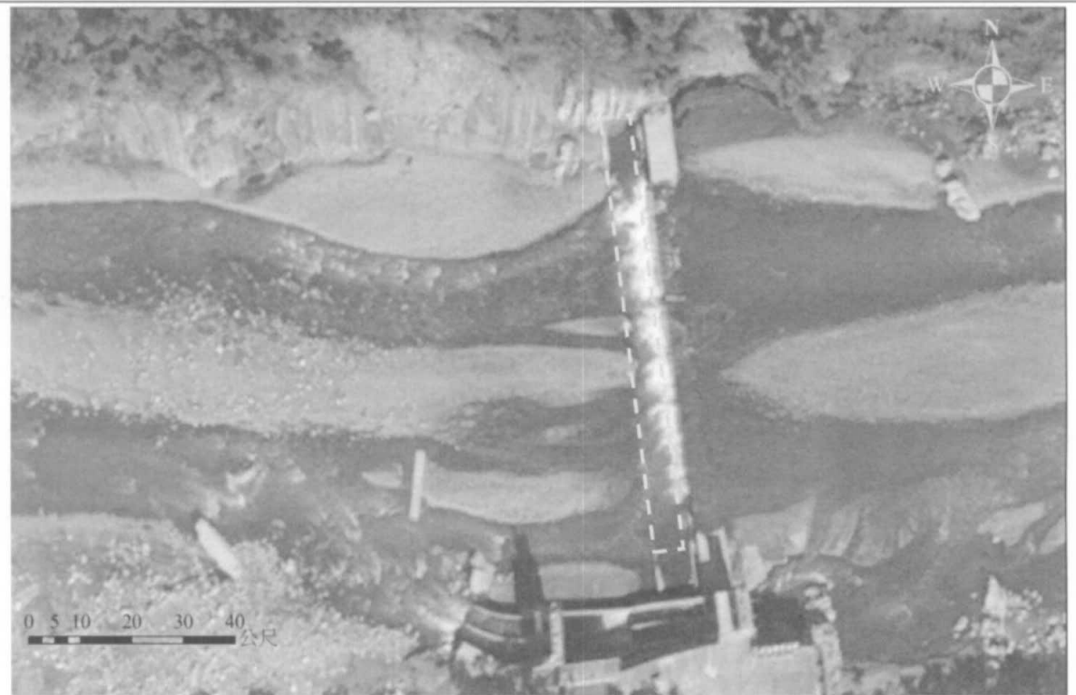
(b) 98.12.12 堰體已修復。堰前沖刷坑已因加設靜水池而覆蓋(圖中虛線方框處)。
