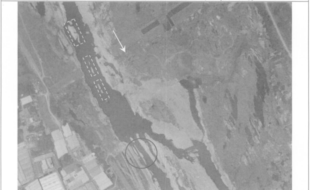
(c) 97.05.17 與圖 5-4(b)比較，堰前與圓圈處河道深槽拓寬，岩盤侵蝕範圍擴大。在圓圈處亦可明顯看見如堰址之砂岩層矗立於河道(虛線方框)。而形成槽溝下切機制發展特徵。
