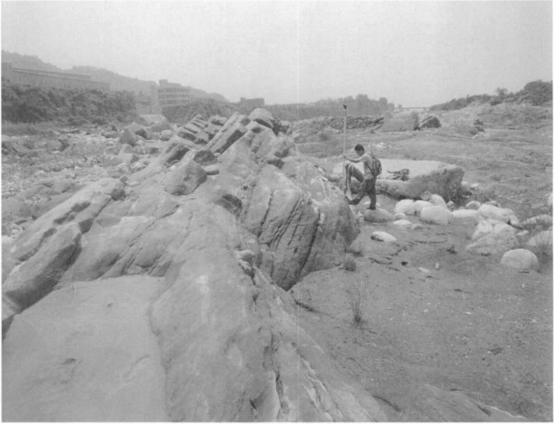
圖 3 - 22 石岡壩堰前層狀砂岩(LSS)
