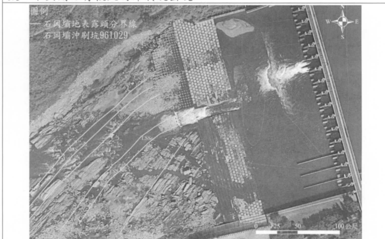
(b) 96.10.29 沖刷坑沿著河道中央節理發達、岩體破碎抗沖蝕能力較低之層狀砂岩(LSS)沖刷，發展成平行走向的不對稱槽溝狀。
