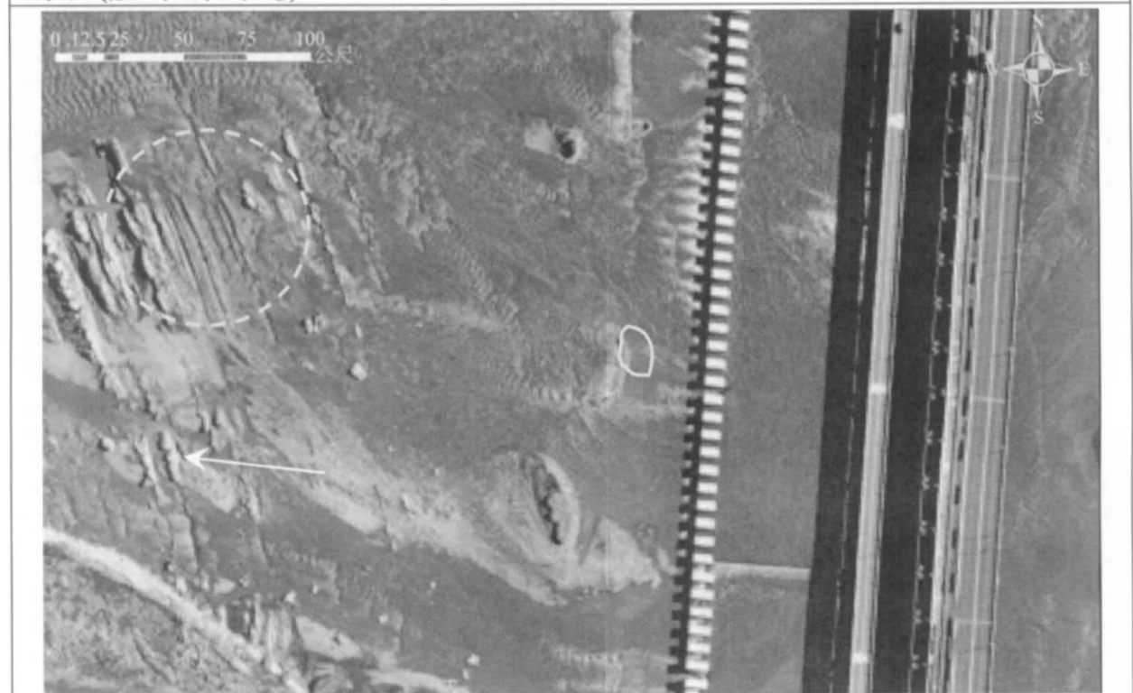
(b) 97.06.10 堰前岩盤出露，沖刷岩盤之沖刷坑形成(實線框選處)，下游河道槽溝下切加深(虛線圓圈處)。
