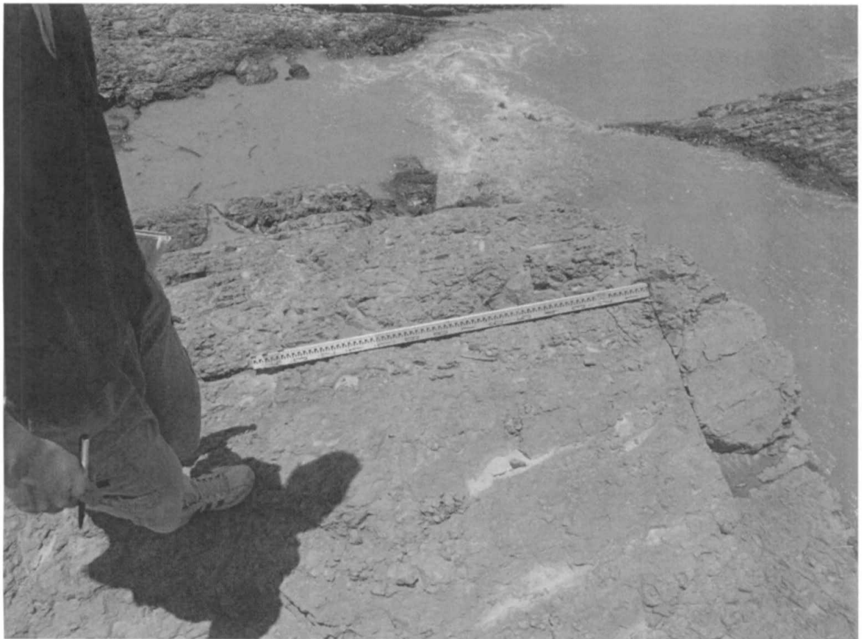
圖 3-67 甲仙堰頁岩之解壓節理及風化現象
