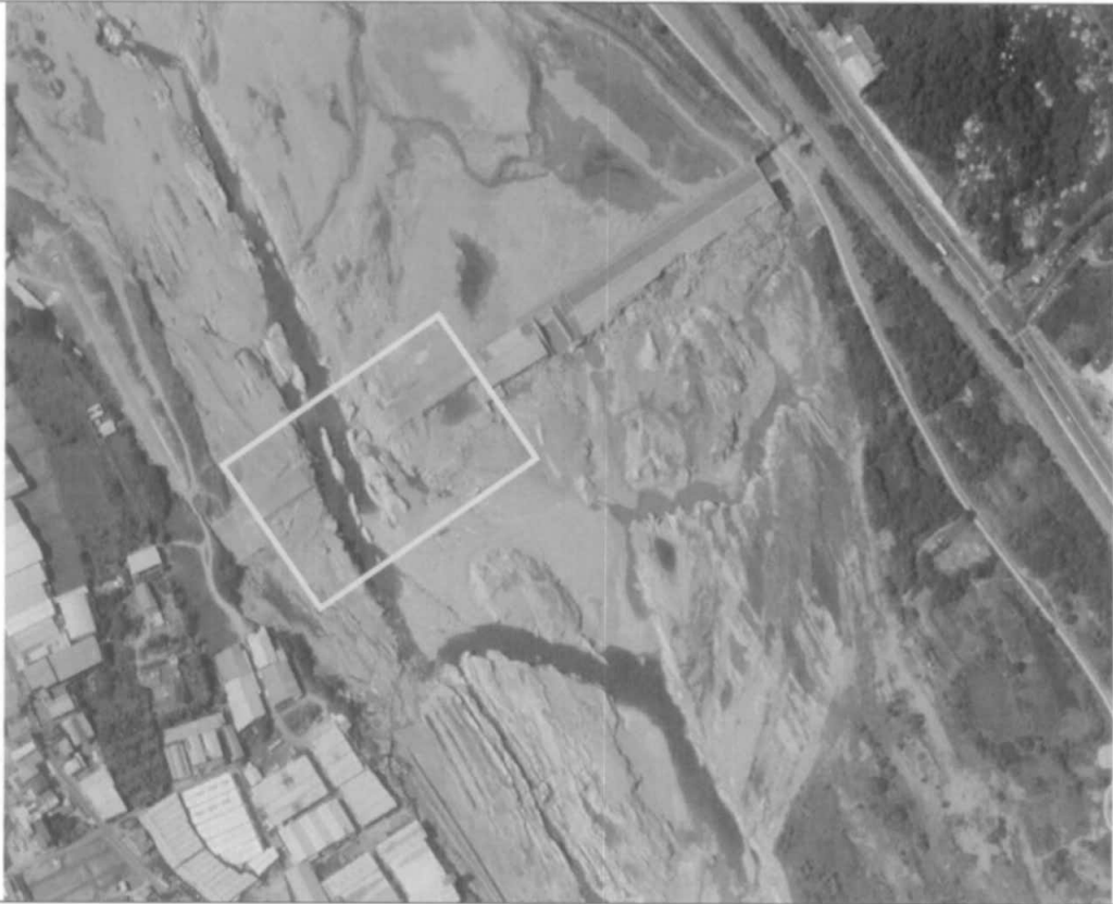
(c) 93.11.07 艾利颱風後。右岸壩體被洪水切穿，河道形成單一深槽，方向大致平行岩層走向。
