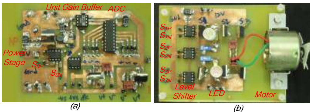
圖24. (a)直流-直流降壓印刷電路板子實際圖(b)馬達及 LED 印刷電路板子實際圖
