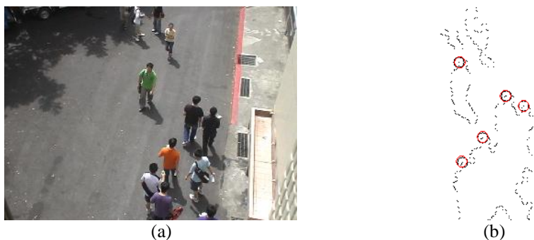
圖 1-8 前景物輪廓區域最高點之偵測，(a) 輸入影像，(b) LMFH 之偵測結果。
