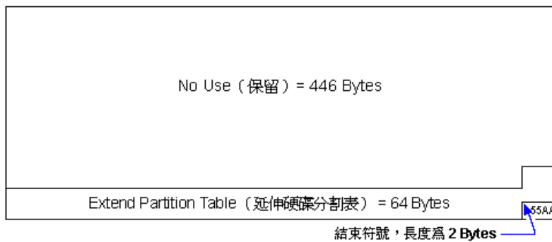
圖表 4-9 邏輯分割第一個磁區的資料結構圖(引用自 http://www.msservermag.com.tw/technicwords/020829.aspx )
