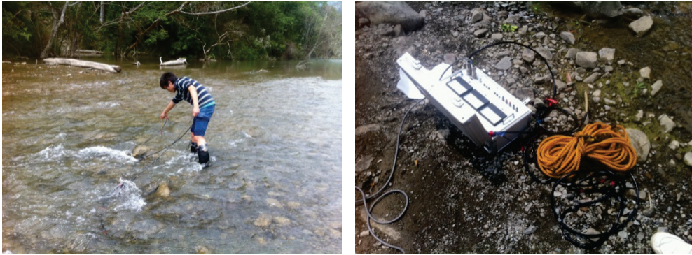
圖 B-6 以流速儀量測流速
