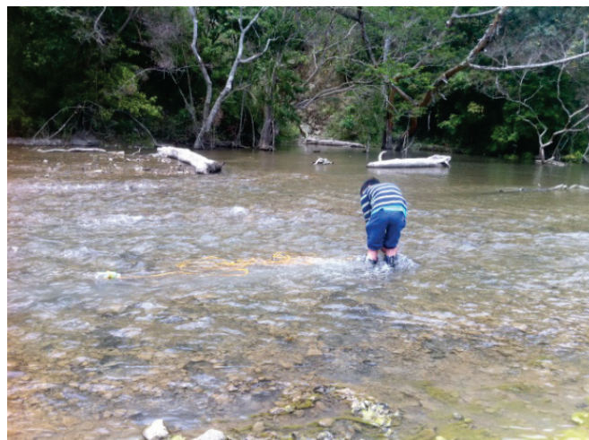
圖 B-5 以漂流物移動速度推估表面流速
