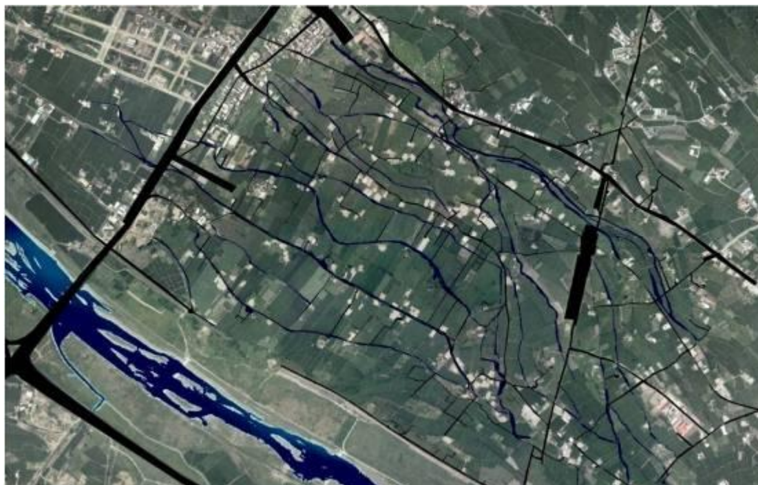
圖 3-1-2 六家庄位於頭前溪與鳳山溪沖積平原的中心地帶，此地區利用原有地形水資源的技術發展完備，可分三部份，分別為 1、源頭分水用的「圓環」2、中游分水的「水汴頭」、「水車」3、載水過河的「水笕」等六家庄的水圳文化。 (資料來源：行政院文建設委員會藝術介入空間計畫，其提案單位為竹北市社區發展協會)
