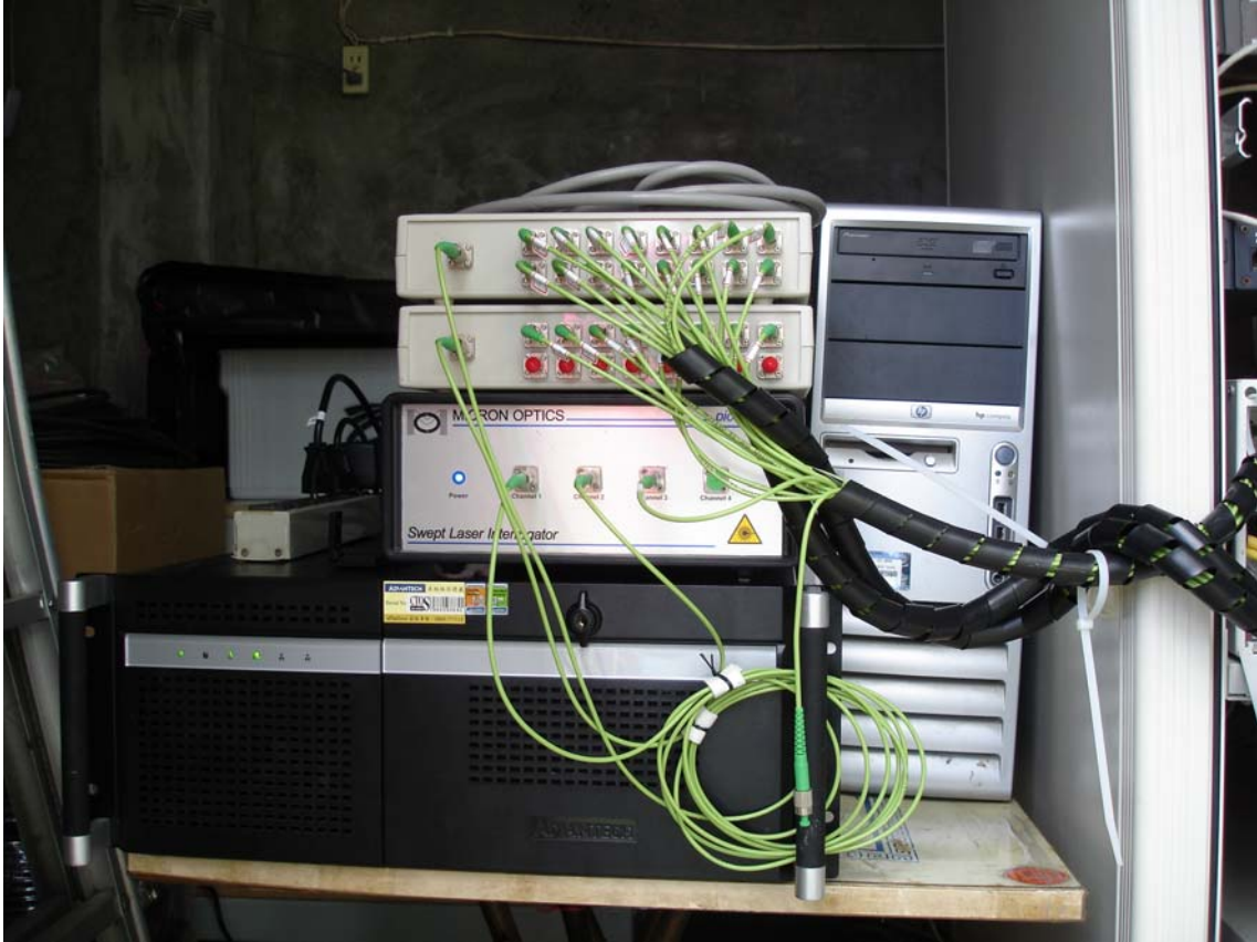
圖 2.10 低耗電量自動化光纖光柵解讀儀器系統
