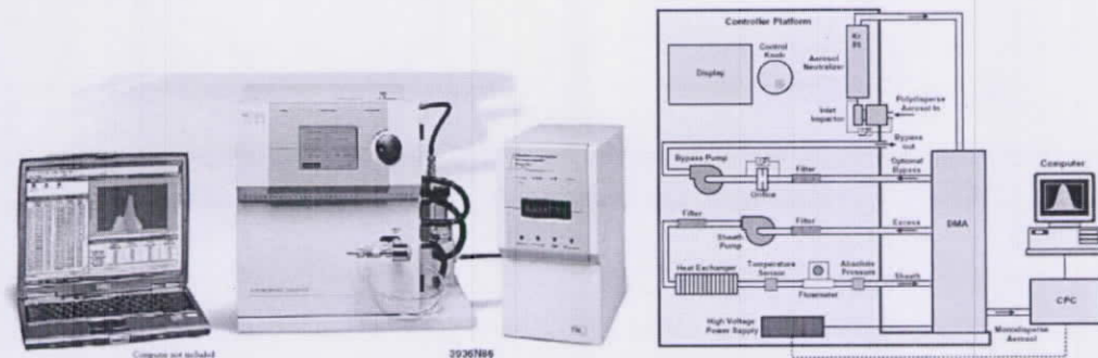
圖 5.10.2 掃描式微粒電動度分析儀 SMPS 的實際照片(左)及構造示意圖(右) ( http://www.tsi.com/uploadedFiles/Product_Information/Literature/Spec_Sheets/SMPS3_936-3034.pdf )。
