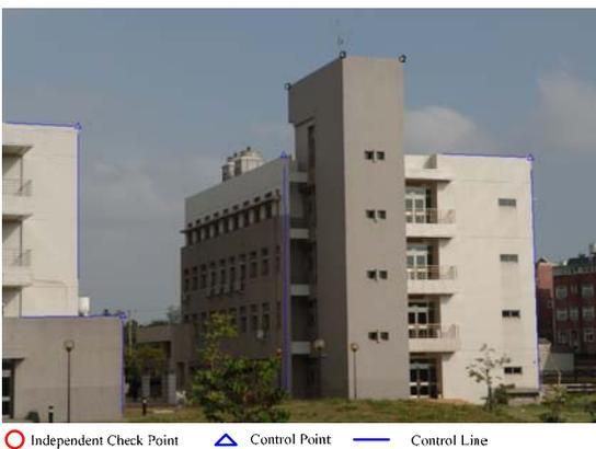
圖 10. 控制點及控制線套疊地面近景攝影影像
