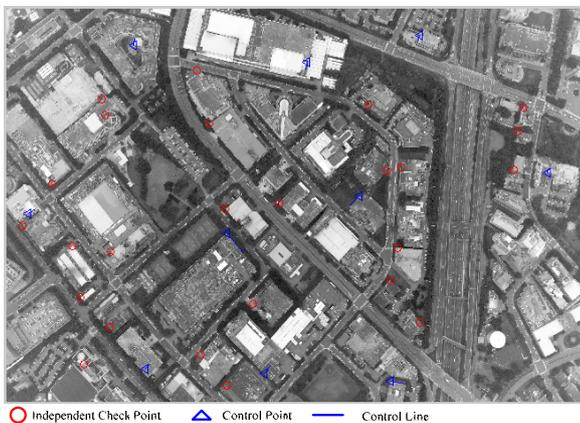
圖 6. 控制點及控制線套疊航空垂直攝影影像
