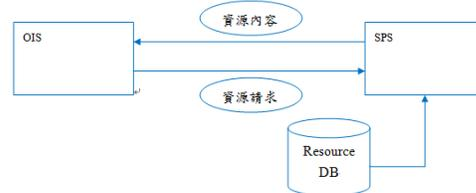
圖 19：服務提供子系統操作概念
