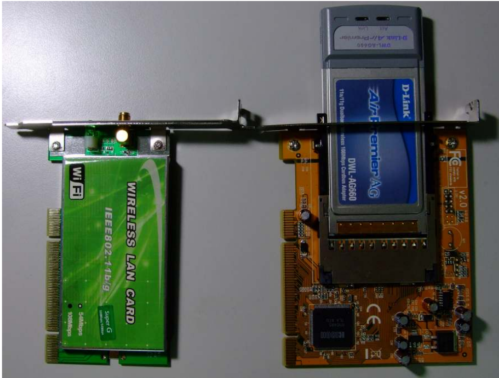
圖(o1) 無線網路界面卡，左:PCI 介面，右:PCMCIA 介面及轉接卡
