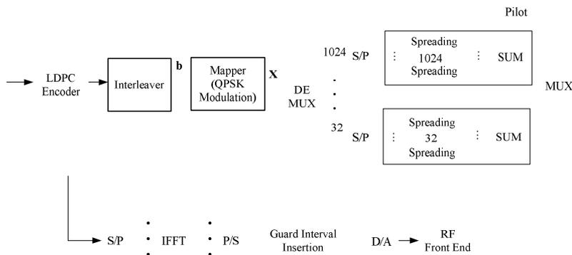
圖 2-2 具有多重碼特性之行動 Wimax 傳送端架構圖
