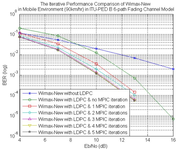
圖4-4 Wimax-New系統於不同遞迴訊號處理之性能比較
