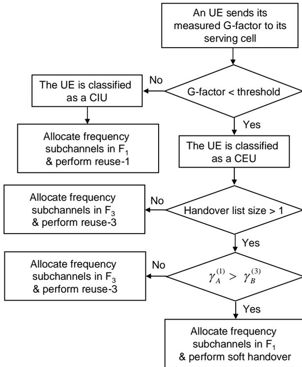
圖6-2 混合方案(hybrid scheme)的運作流程圖
