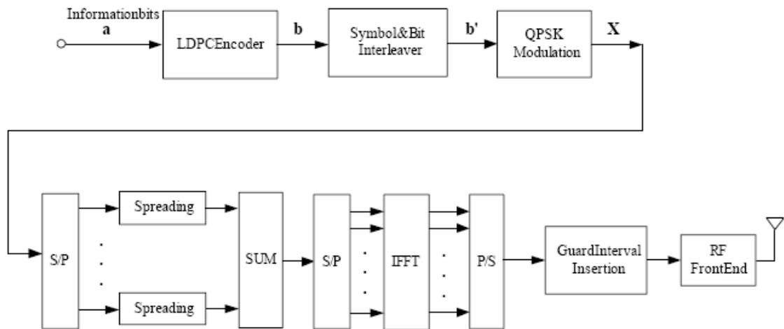
圖1-1 結合多重編碼改良後傳送端架構圖
