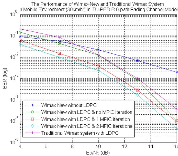
圖4-1 Wimax-New與傳統Wimax系統之比較
