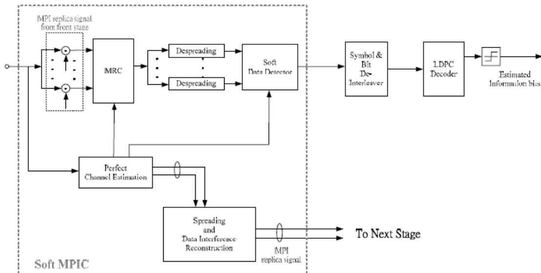
圖1-3 結合多重編碼改良後接收端多路徑干擾消除模組架構圖
