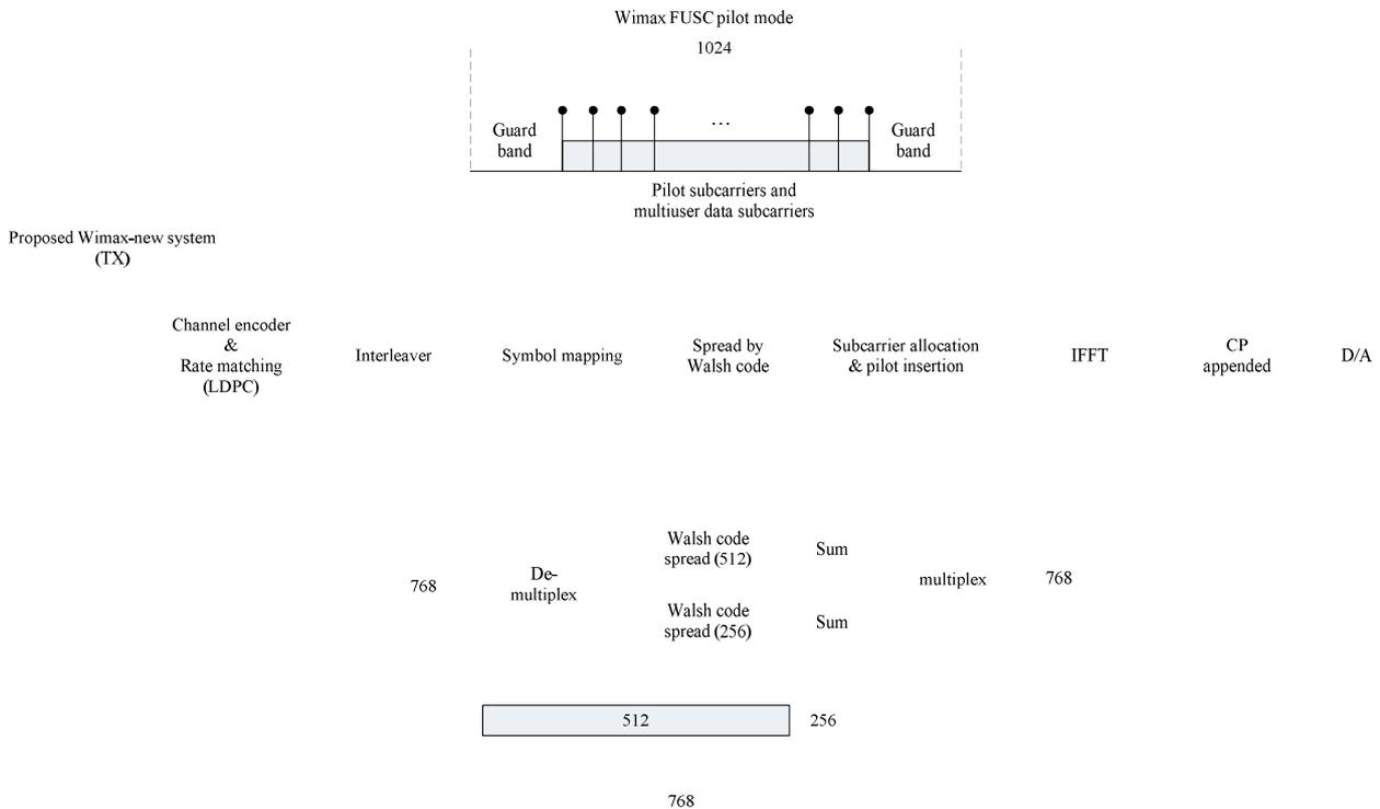
圖3-1 Wimax-New傳送端模型與訊號載波設計
