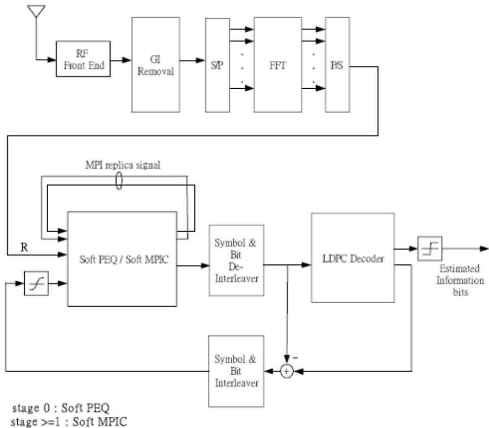
圖 1-4 結合多重編碼改良系統下的渦輪等化技術架構圖
