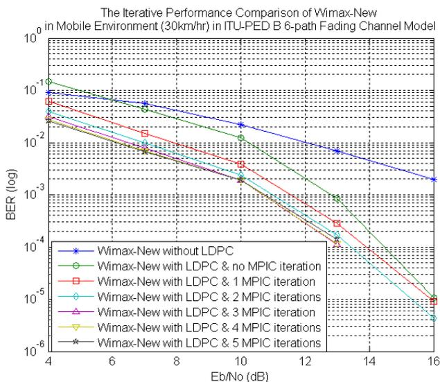
圖4-2 Wimax-New系統於不同遞迴訊號處理之性能比較
