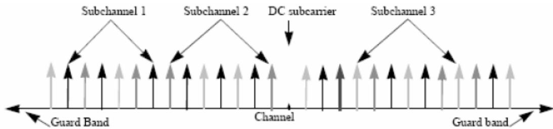
圖0-1 OFDMA 符元結構示意圖
