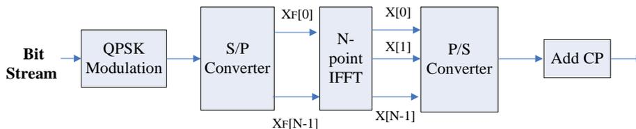
圖5-1 OFDM傳送端模型
