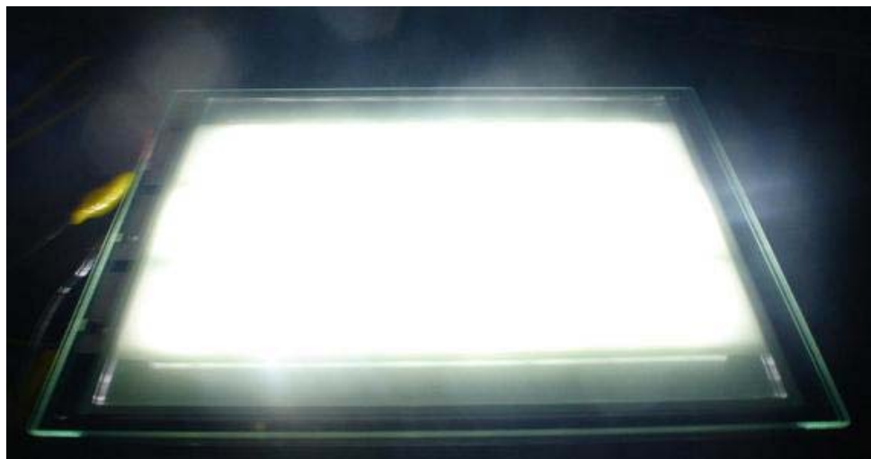
[圖三十四] 無汞尖端電極場增強型平面電漿光源在 50 托耳的純氬氣氣體環境下，利用 5 萬赫茲且 260 伏特的直流雙極電壓驅動下產生的面板點亮圖。
