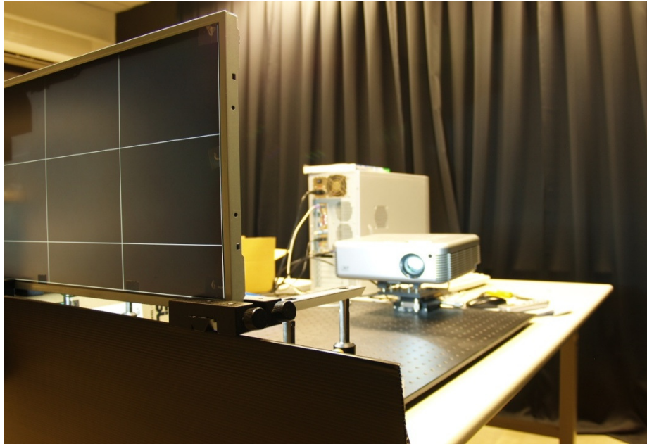
圖 39、以投影機提供動態背光光場之驗證平台
