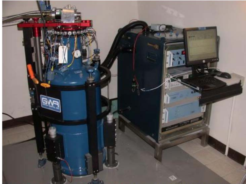
(1)杜瓦瓶內裝低溫液態氦與超導材料 (2)電子控制單元及資料擷取單元 組成重力感測器
