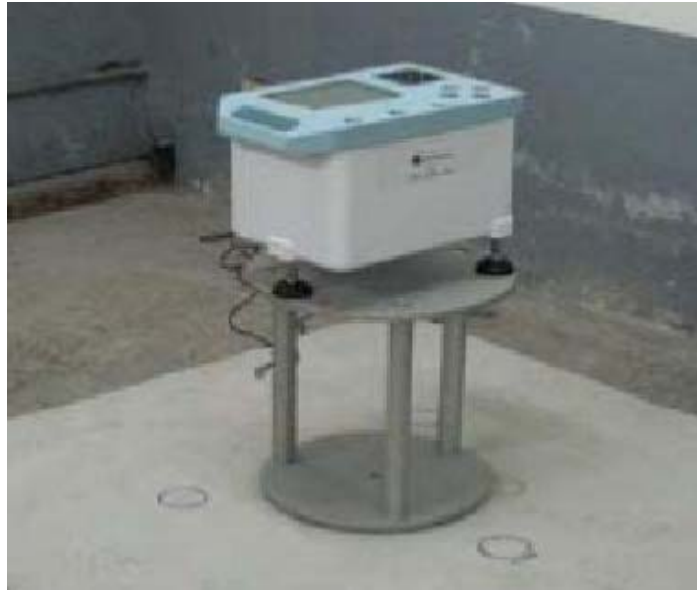
圖4：相對重力儀EG 配合重力架觀測梯度
