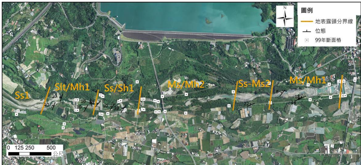
圖 70 八掌溪地表地質與沖蝕調查區域(仁義潭攔河堰至 95 斷面)
