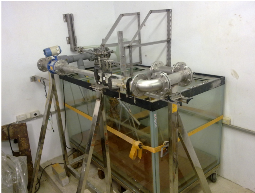
圖 96 多功能沖蝕儀-可變角度射流沖刷試驗設備照片
