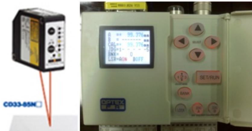
圖 103 雷射位移計與雷射位移數據擷取放大器
