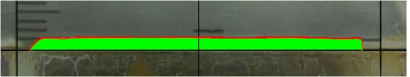
圖 93 數化後的試驗岩心(紅色部分為沖刷實驗前，綠色為沖刷後)
