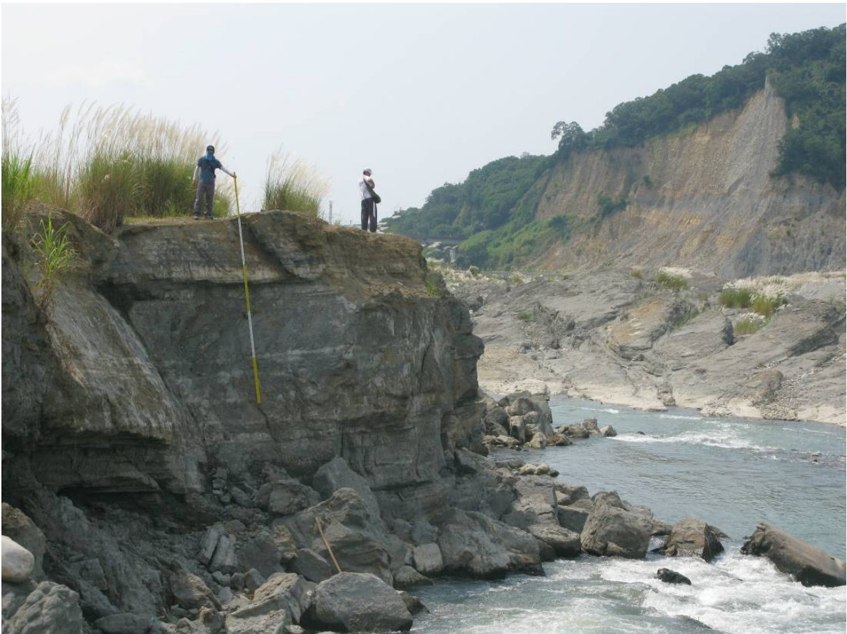
圖 61 大甲溪—塊狀砂岩常沿所夾頁岩破壞
