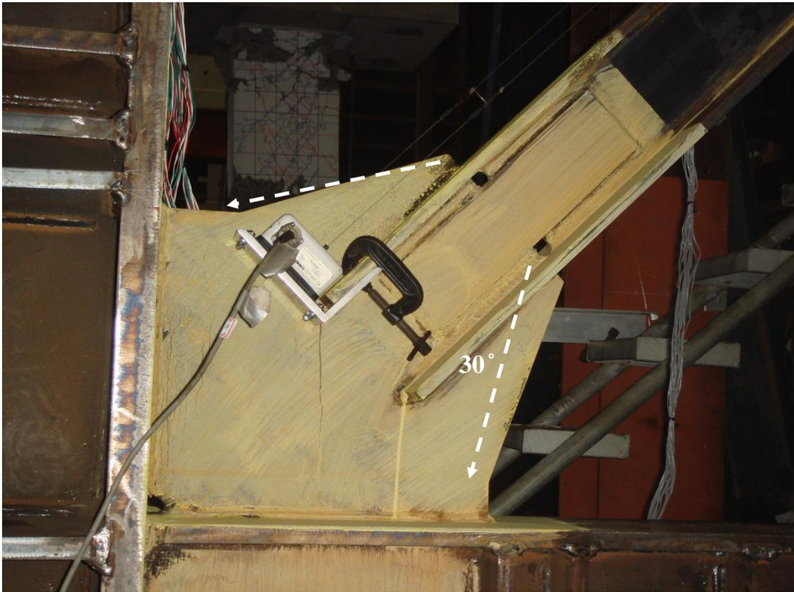
圖 4.39 下接合板於 30°擴散角區域石膏 45°剝落情形 (0.25% 弧度 IDA)
