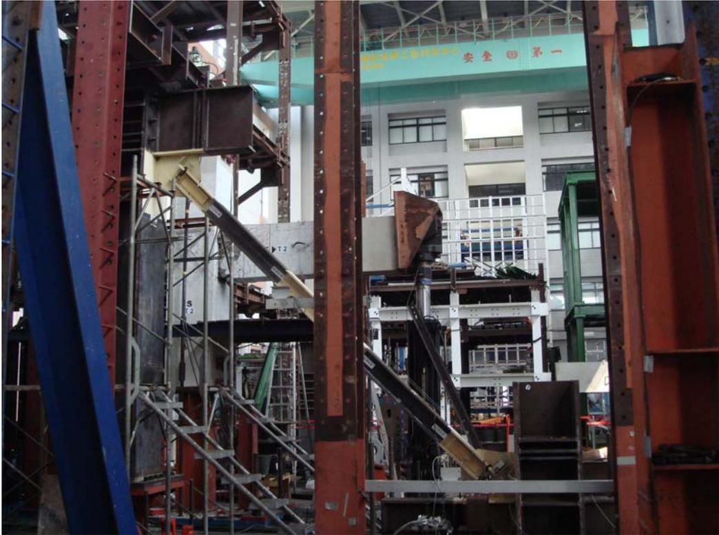
圖 4.30 載重試驗構架設置圖
