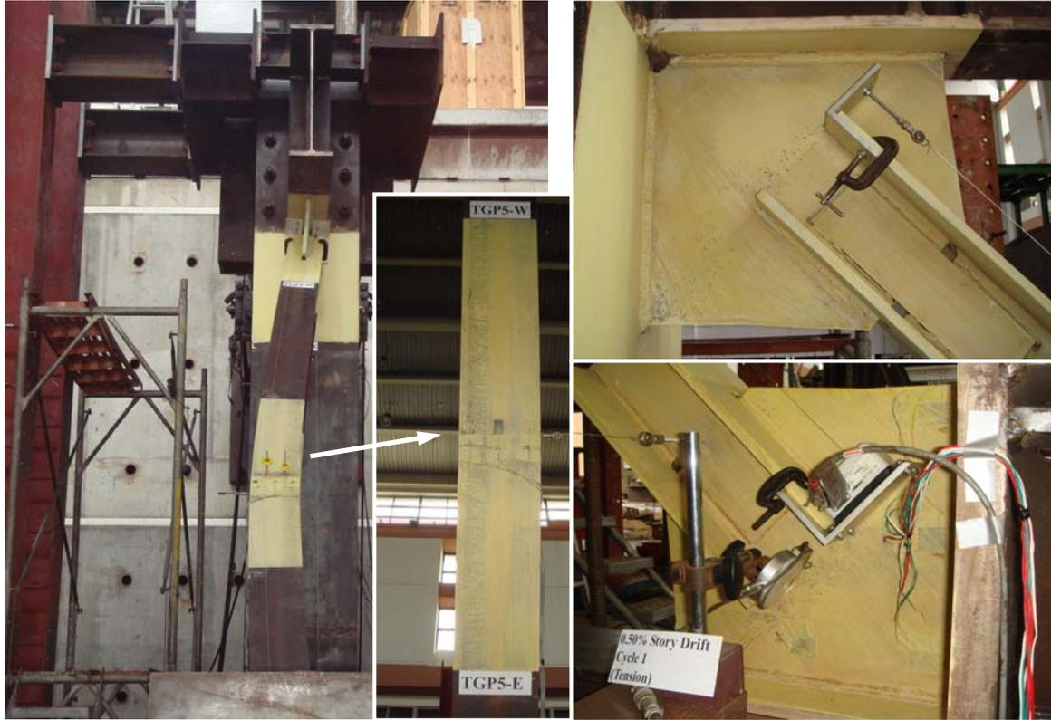
圖 4.54 斜撐初始挫屈與接合板受力行為 (0.5% 弧度 IDA)
