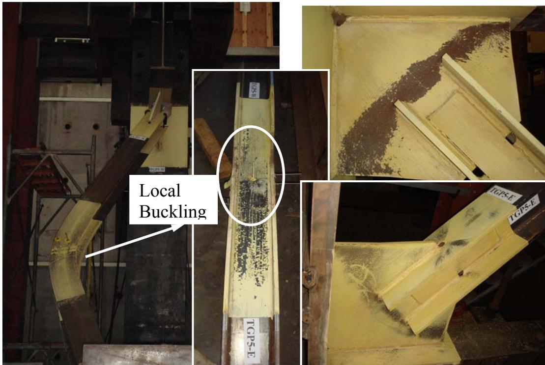
圖 4.57 試體 TGP5 最終破壞行為 (6% 弧度 IDA)
