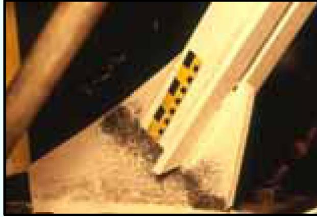
圖 2.1 含 2t 鉸區域長度之接合板凹折變形情況 (Astaneh-Asl et al. 1982)
