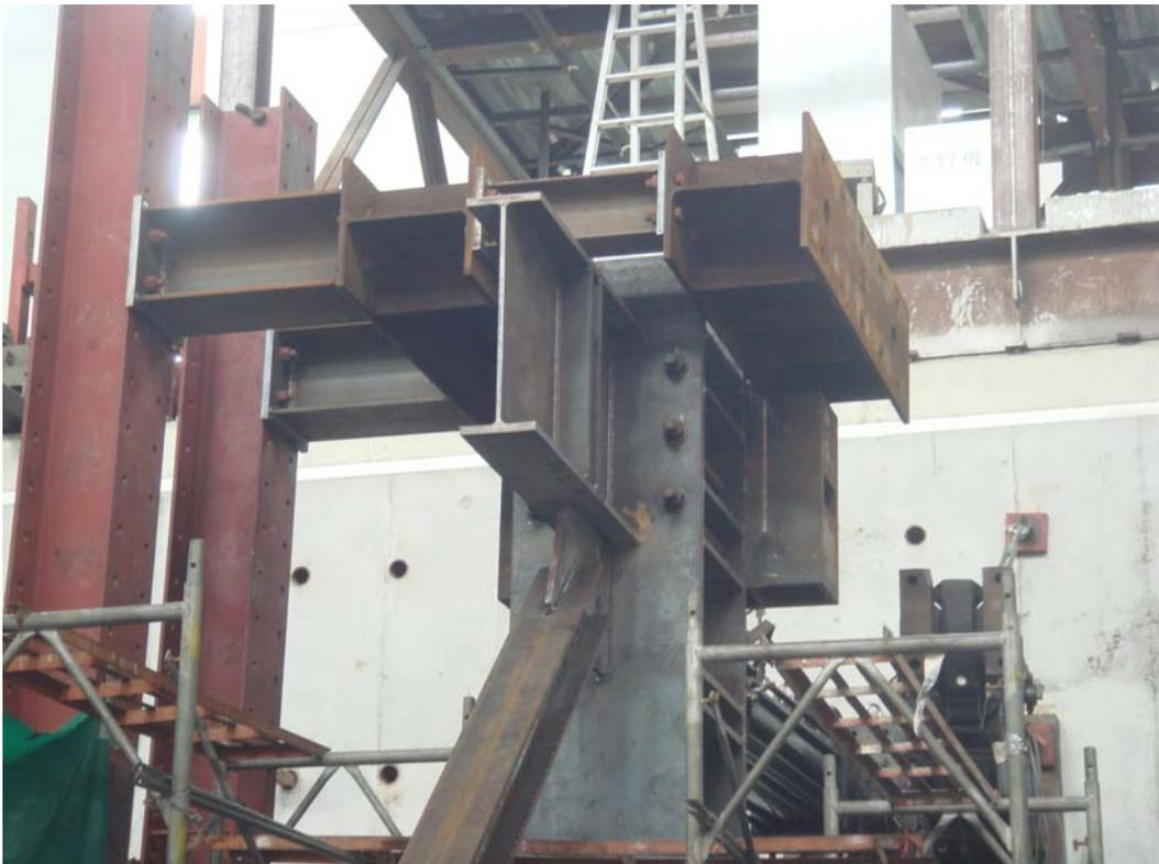
圖 4.31 柱端之側向支撐系統
