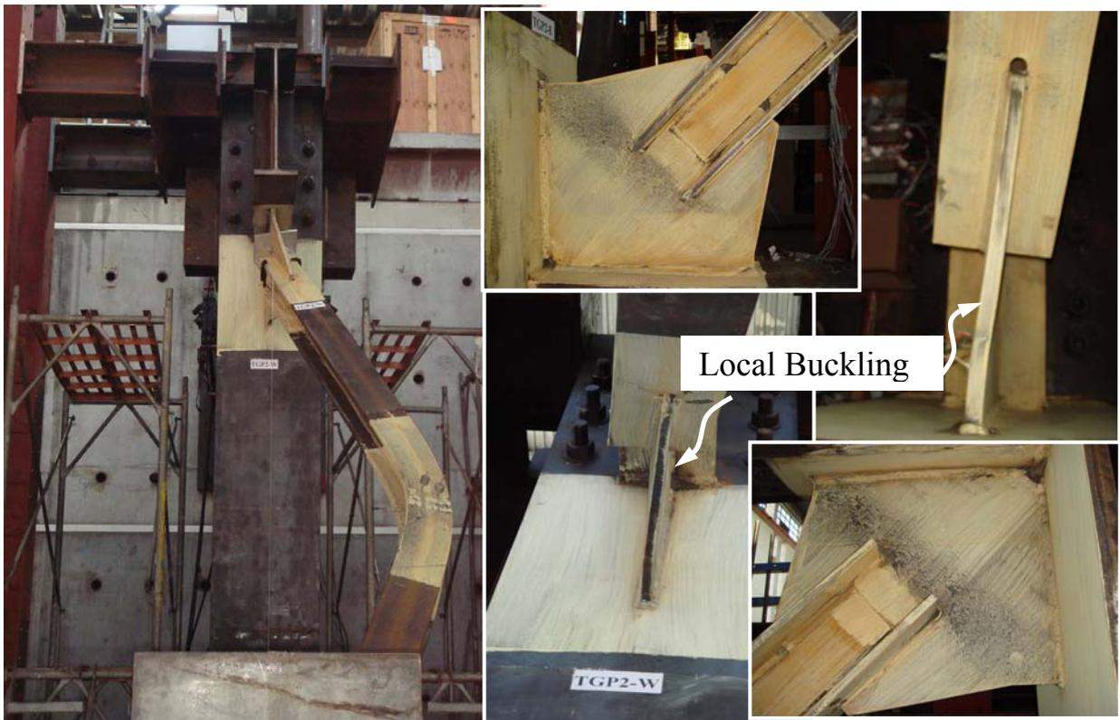
圖 4.47 試體 TGP2 最終破壞行為 (5% 弧度 IDA)
