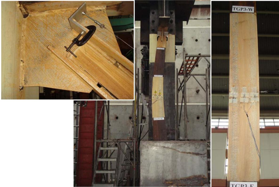
圖 4.48 試體 TGP3 初始挫屈與接合板凹折紋路情形 (0.5% 弧度 IDA)
