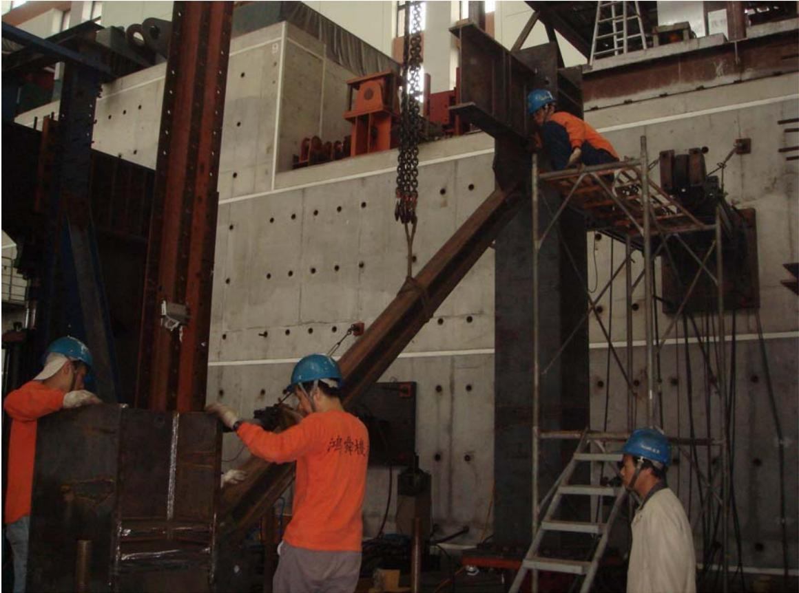
圖 4.22 斜撐構材吊裝
