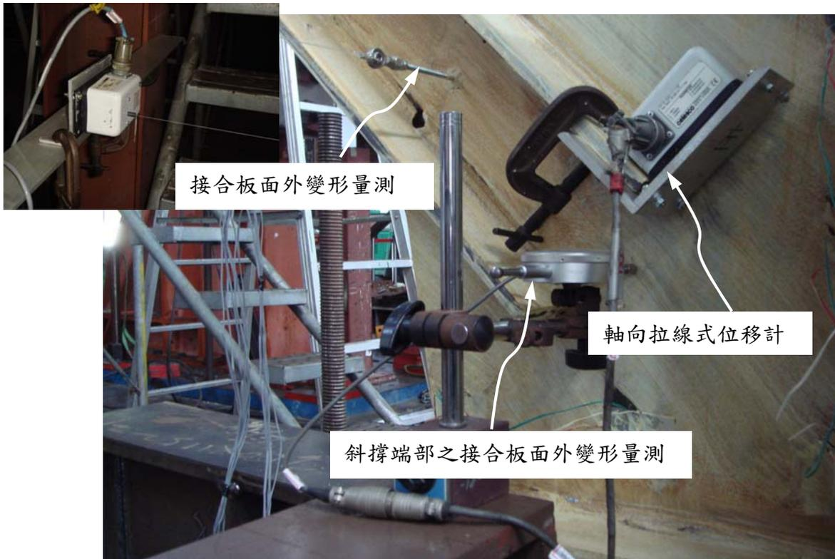
圖 4.35 斜撐與接合板各儀器架設實況
