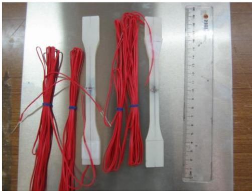
圖 9 奈米材料標準試片
