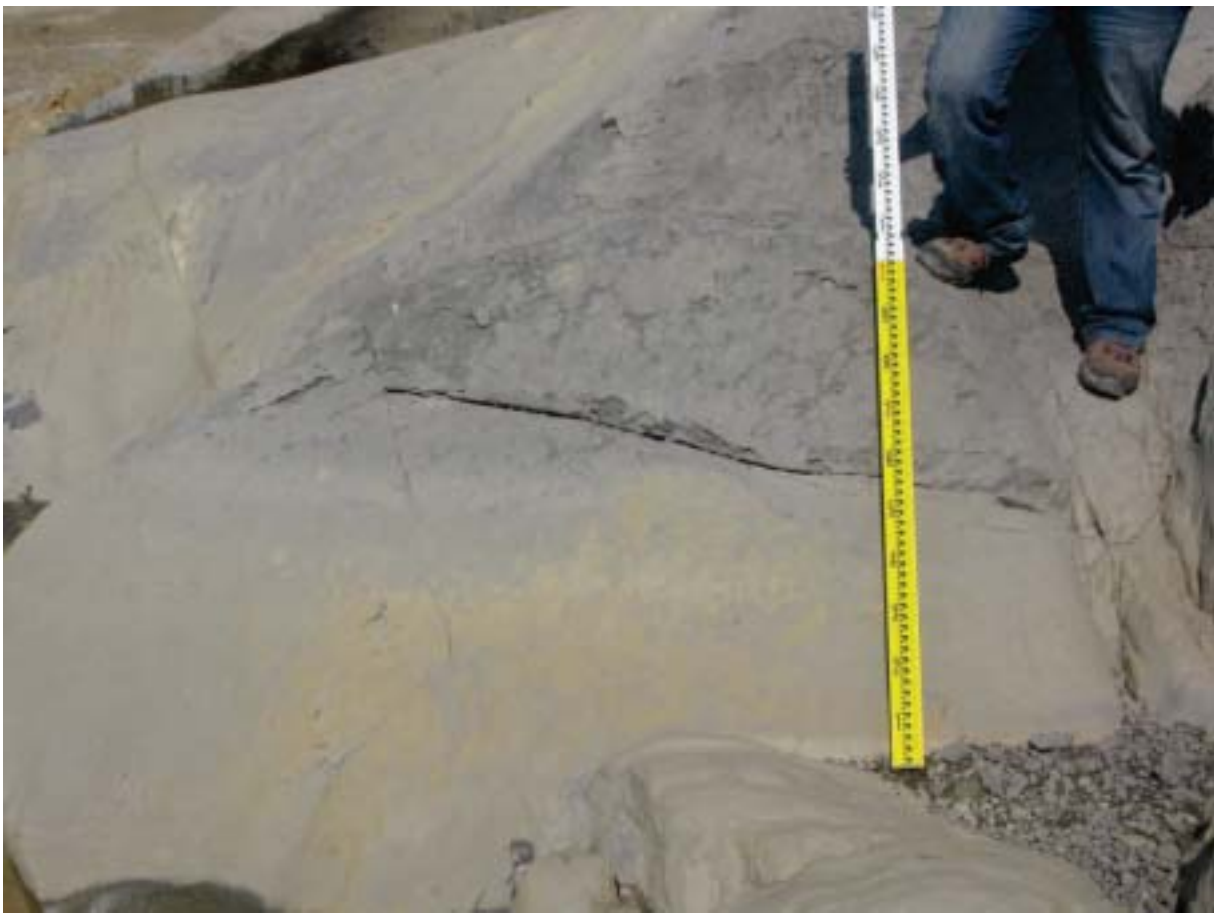
圖 3-45 甲仙堰新鮮頁岩的解壓節理
