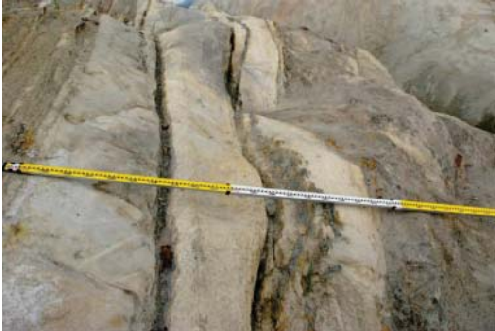
圖 3-6 中度風化之砂頁岩互層節理狀況
