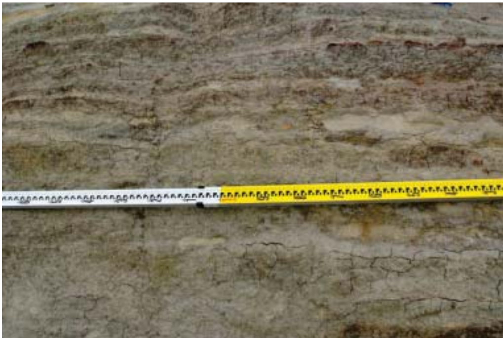
圖 3-7 高度風化之砂頁岩互層節理狀況
