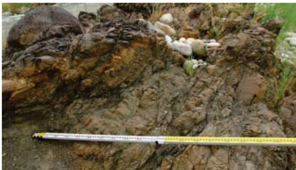
圖 3-9 夾煤層、砂頁岩互層經風化、解壓形成破碎岩體
