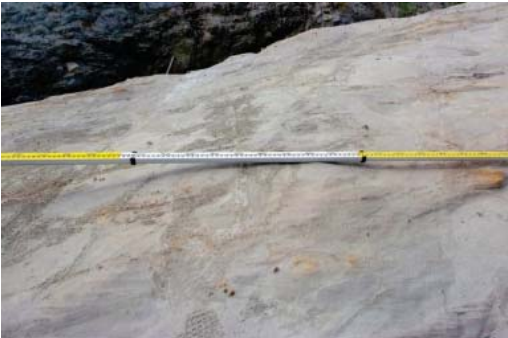
圖 3- 5 低度風化之砂岩節理狀況
