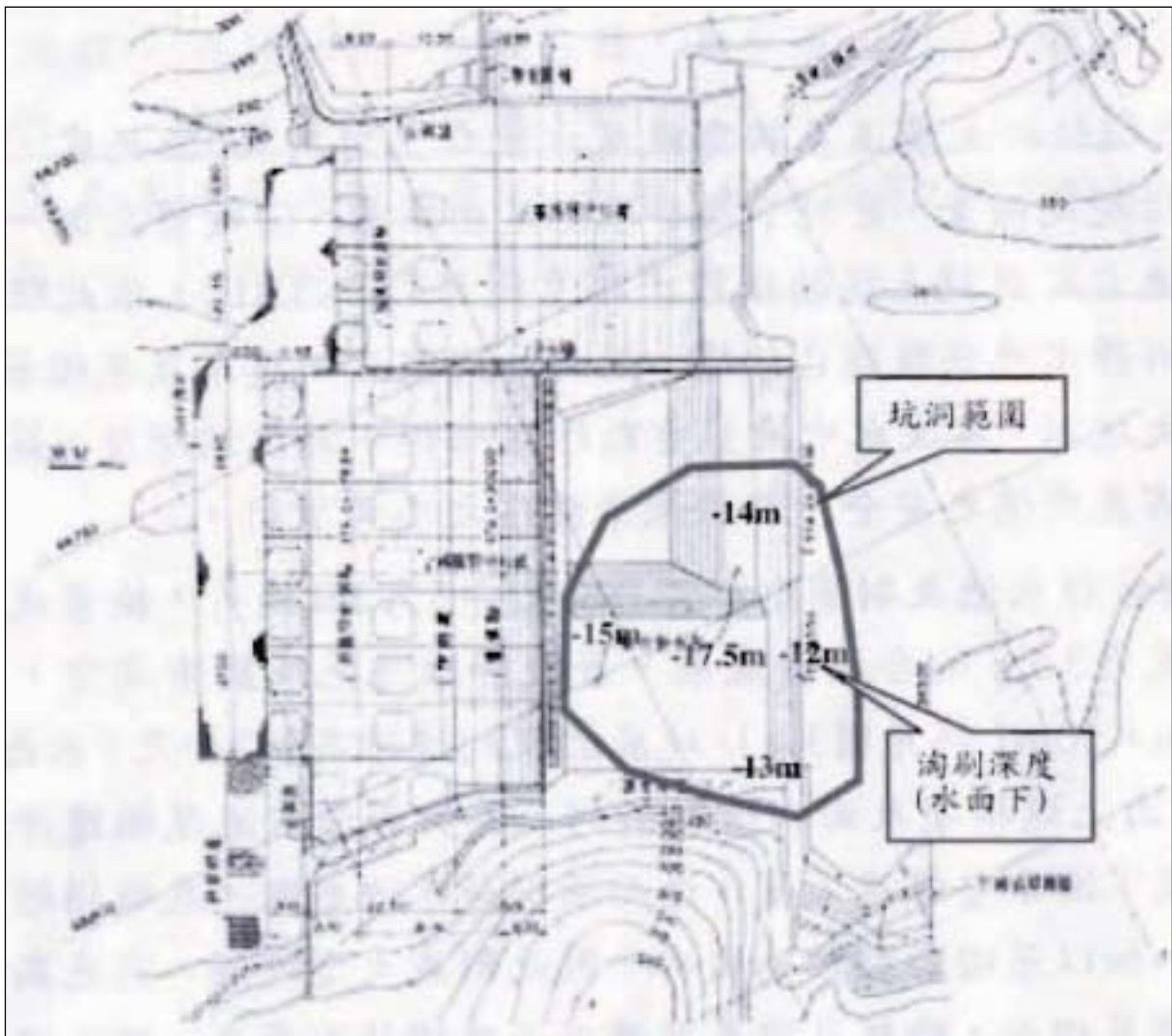
圖 2-19 義興壩下游靜水池掏刷坑範圍及深度 (水利署，92 年)
