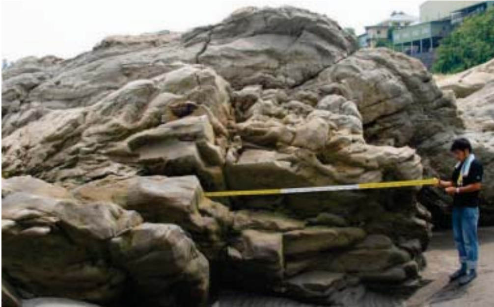
圖 3- 19 斷層附近的破碎岩體(226186, 2686086)
