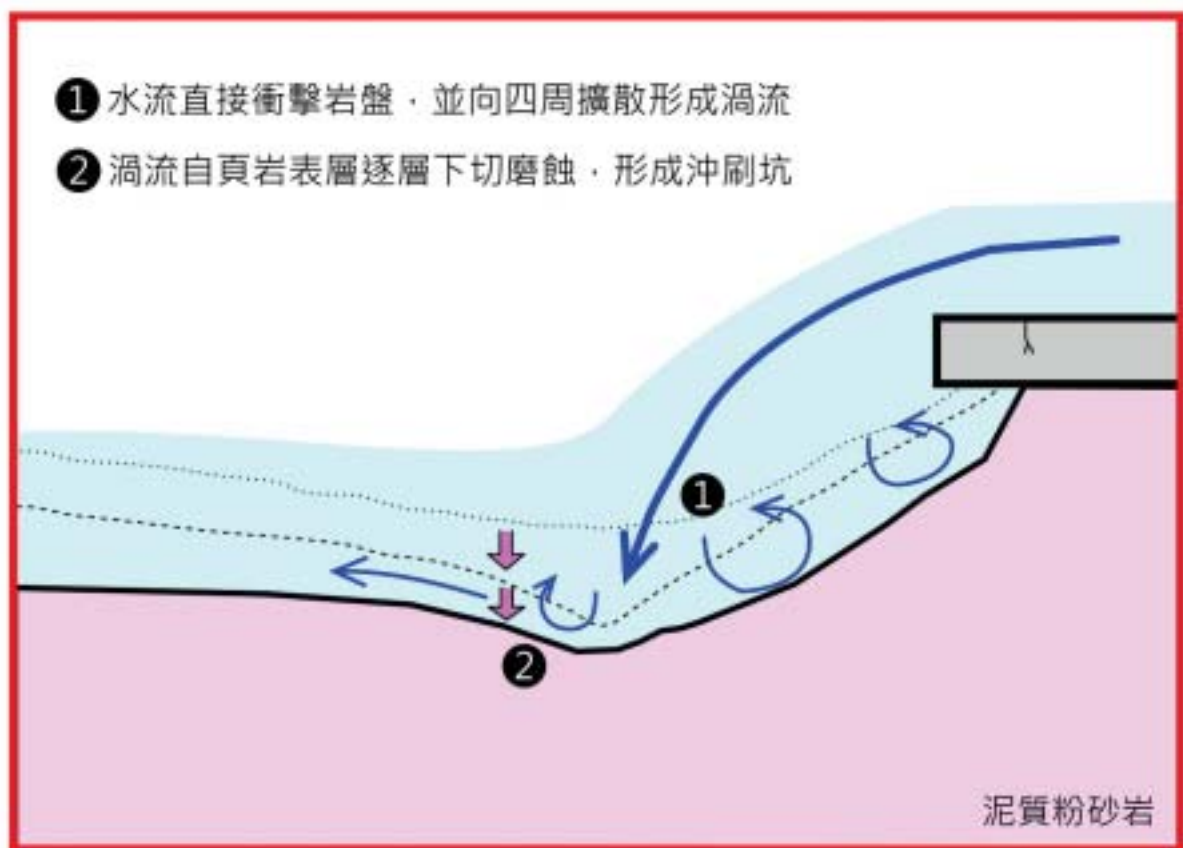
圖 5-24 均勻下切型沖刷示意圖
