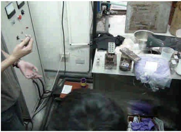
圖九 利用充磁機使磁鐵帶磁性
