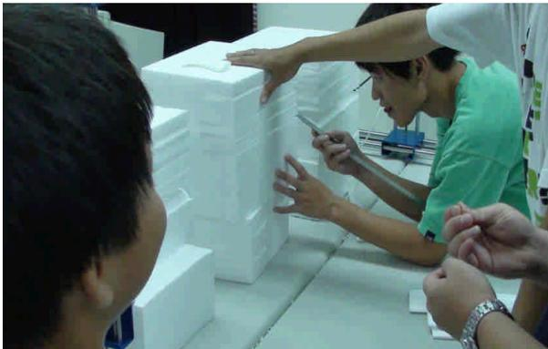
圖十一 使用熱線切割機製作保利龍葉片
