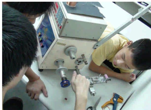
圖八 利用繞線機自製漆包線圈
