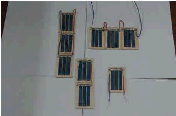
圖十七 太陽能板的串、並聯實驗
