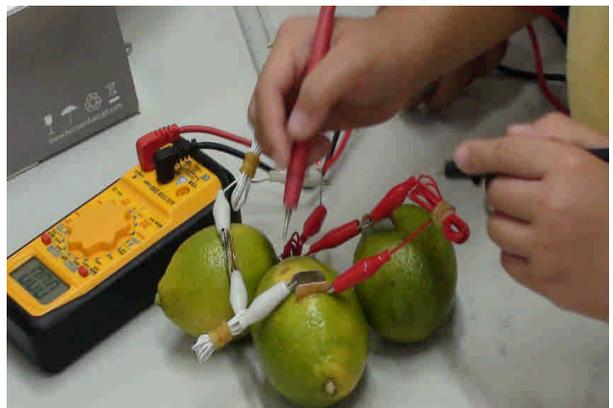
圖二十 水果電池測試實驗
