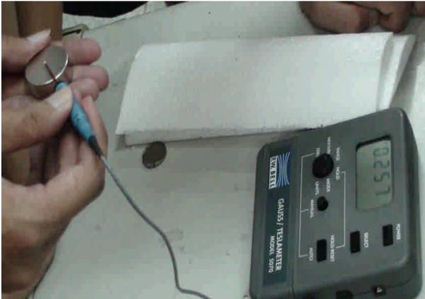
圖十 使用高斯計來量測磁鐵磁通密度
