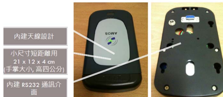
圖 2：HF RFID 小型讀取器(用於互動資訊站短距離讀取使用)
