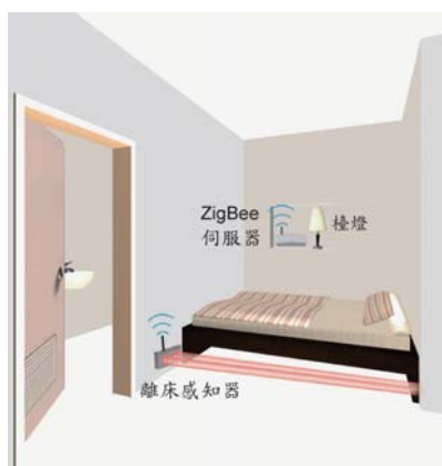
圖 3-6 安潤科技贊助之 ZigBee 離床感知系統可偵測老人夜晚起身離床狀況(價值 5 萬元)
