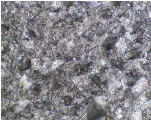
圖一 使用粒徑為  $30\ \mu\text{m}$  的鑽石粉，研磨盤轉速為  $45\ \text{rpm}$ ，研磨時間為 20 分鐘之表面型態圖
