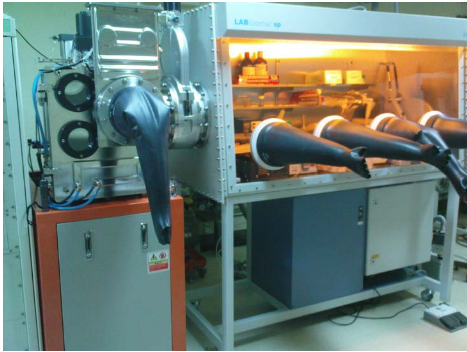
圖二 製程機台實體照片，為手套箱跟熱蒸鍍機串接之製程系統實體照片。
