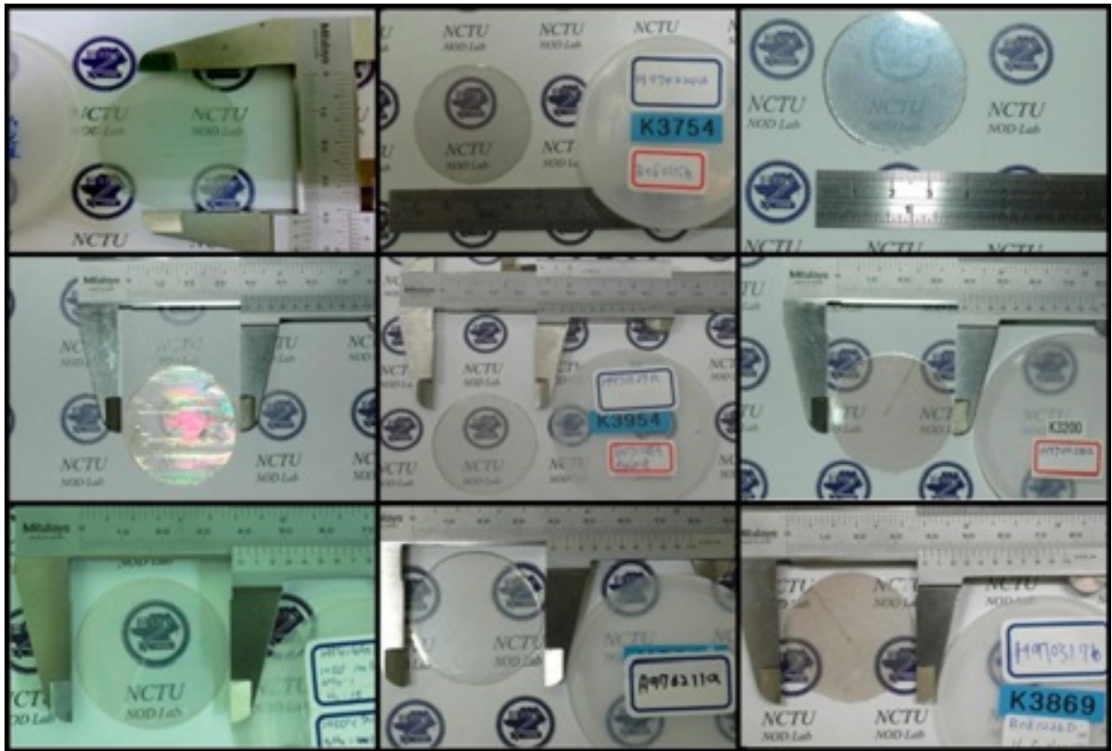
Fig 5.16 由 LLO 系統剝離之 1.5 inch Freestanding GaN (李威儀教授實驗室)
