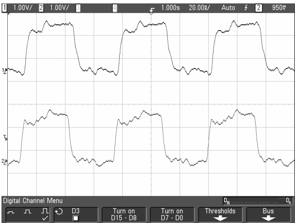
圖 29 鎖定後除頻器與中頻訊號的輸出波形
