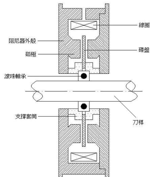
圖 1 MR 流體制振器設計示意圖
