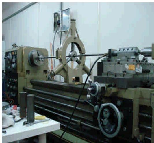
圖 4 深孔鑽之精準制振與貧油潤滑實驗機台
