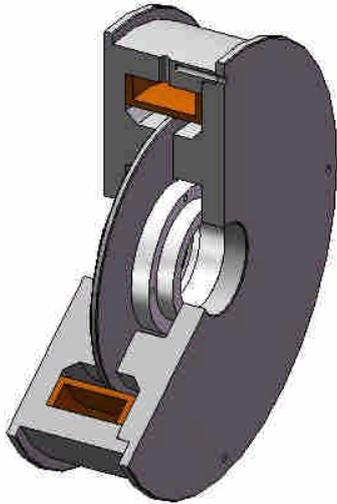
圖 2 MR 流體制振器 CAD 示意圖
