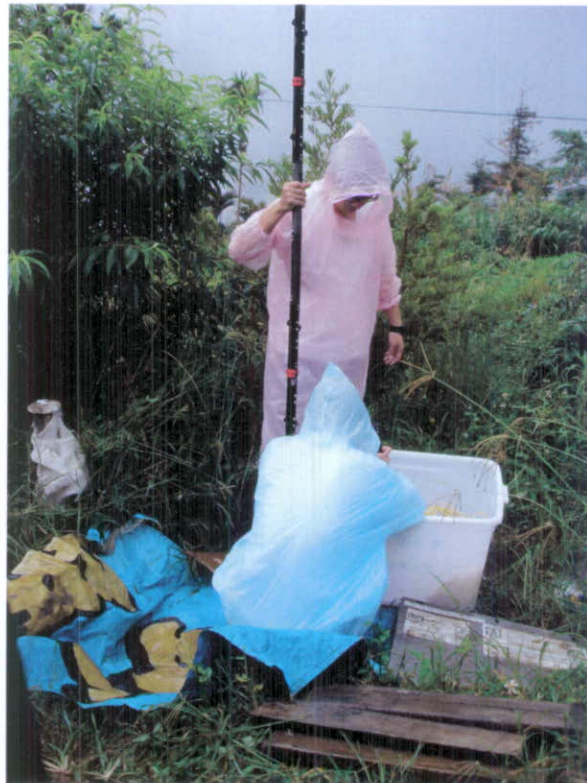
圖 2.10 NCTU-01 20 組 FBG-SD 重新裝置
