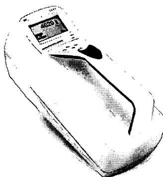
圖 33 手提式核凝微粒計數器照片[94]。
