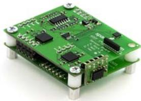
圖六 姿態感測器(IMU 6DOF v4)。
