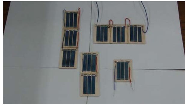
圖十六 太陽能板的串、並聯實驗
