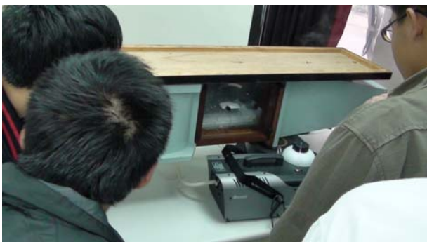
圖五 利用風洞觀察流線與停滯點
