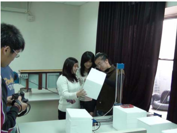
圖十 使用熱線切割機製作保利龍葉片
