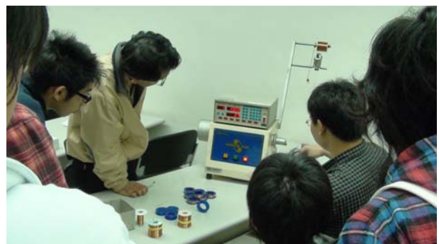
圖七 利用繞線機自製漆包線圈
