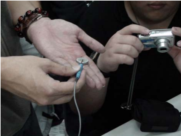
圖九 使用高斯計來量測磁鐵磁通密度
