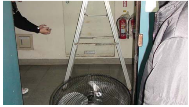
圖六 觀察翼型受風力產生向上升力
