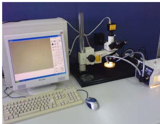
圖 12. 顯微影像觀測系統硬體架構圖。
