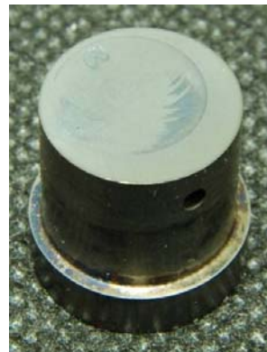
圖 33 實驗編號 5 之實驗後上模仁圖
