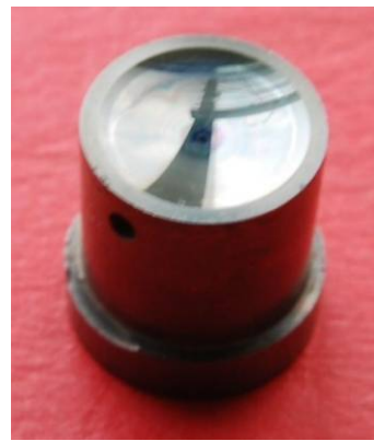
圖 29 實驗編號 3 之實驗後下模仁圖
