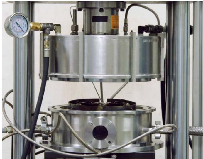
圖 48 紅外線真空加熱爐外觀圖
