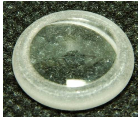
圖 27 實驗編號 3 之透鏡成品圖
