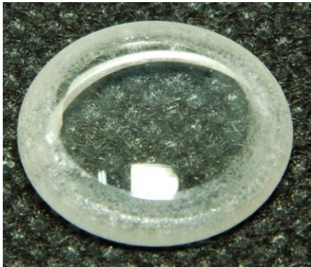
圖 26 實驗編號 2 之透鏡成品圖
