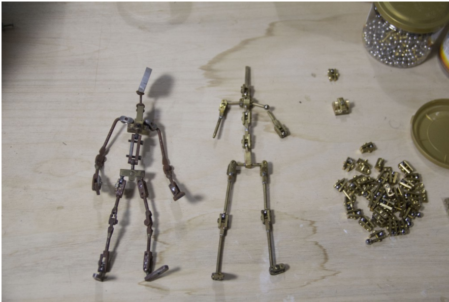
戲偶的骨架有屬於鐵製的（左）和銅製的（右），呂文忠說：「左邊的鐵製骨架是由教授親手製成的；右邊的銅製骨架是現在他們團隊所使用的，比較不容易生鏽。」而每個精細的小關節要價昂貴，加上加工與自製戲偶製作對於作品本身無疑是個關鍵，但同時卻也是經濟上的一大挑戰。（照片來源／侯怡安攝）
