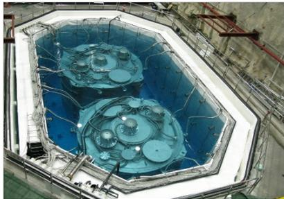
大亞灣近點實驗室內的第一對反微中子探測器，各為五米高五米直徑，已放置於注滿純水的水池內。水池周圍的光電倍增管，其目的在於探測宇宙射線，降低宇宙射線的干擾。
