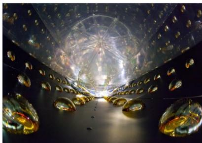
圖為反微中子探測器內部結構，探測器周圍佈滿光電倍增管，內部裝有四米與三米的壓克力桶。其中台灣團隊負責製作最內部的三米壓克力桶。
