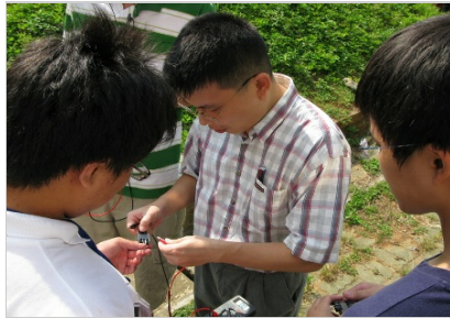
黃立心助理教授指導學生用三用電表測量自己親手製作的太陽能電池
