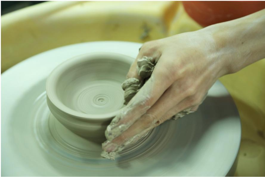
手拉坯使用的旋轉機器，昔日稱為「石回仔車」或「轆轤」，利用旋轉產生的離心力、水的潤滑，再加上熟稔的技術來塑造黏土的形狀，捏出杯子、碗盤等造型。（照片來源／杜以翔攝）
