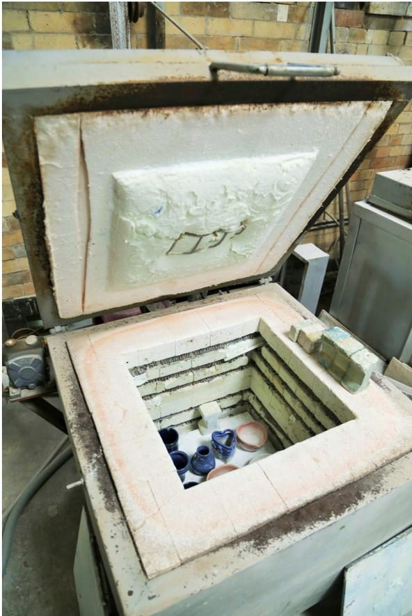
圖中設備為電窯。傳統的柴窯因為燃燒木材會產生空氣汙染，現在都改以電窯來燒製陶瓷，燒製完成的作品，在窯中冷卻後才能拿出。
