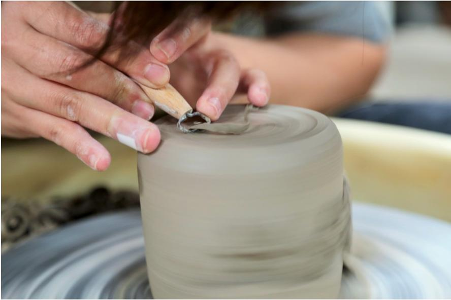
這個步驟稱為「修坯」，師傅將每個作品的底部修整為較美觀且平穩的樣子，在燒製出來後更賞心悅目，也能替遊客的作品畫龍點睛。（照片來源／杜以翔攝）
