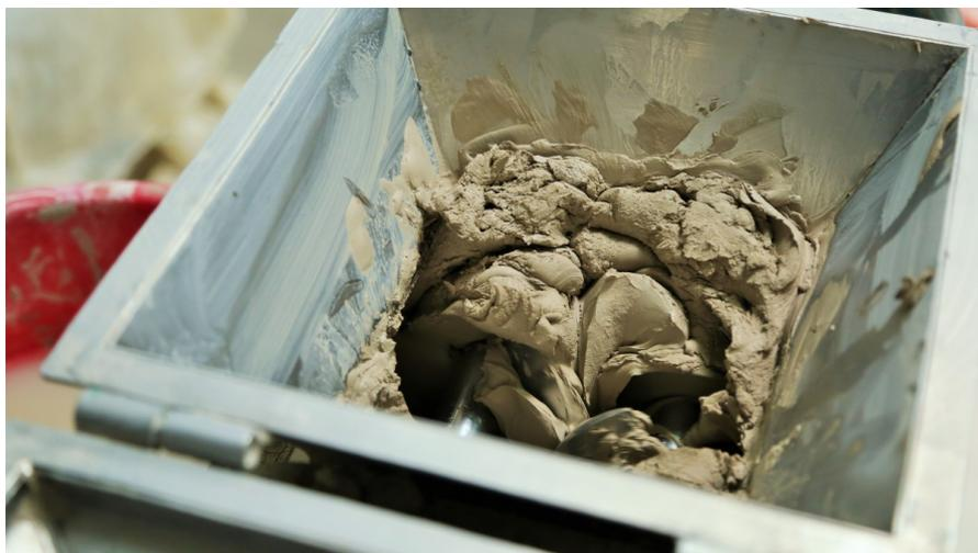
在製作陶瓷前，必須先經過「揉土」這個步驟，把陶土放進真空機內運轉，將不要的雜質與空氣排除，才能減少燒陶時的失敗率。泥土若含空氣，當燒窯達到一千兩百度的高溫時，會因熱脹冷縮使得坯體爆裂。
