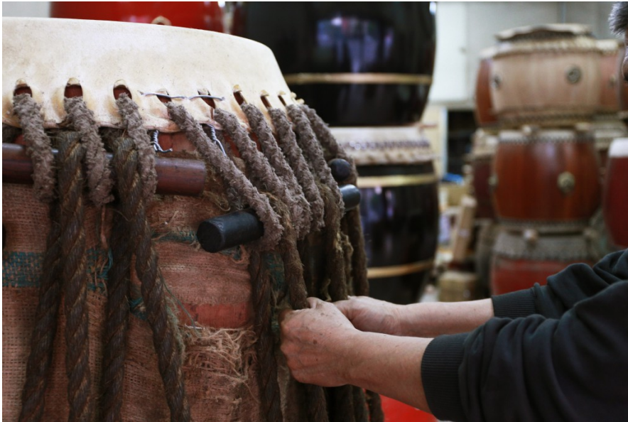
放上牛皮後，再綁上麻繩用力拉緊，這個步驟為「繃鼓」，對於鼓的音階有很大的影響。 （照片來源／陳珮容攝）
