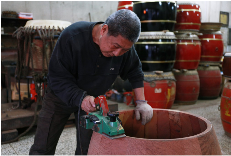
將木片拼裝成鼓桶後，王錫坤仔細地刨光，讓鼓表面的材質更加平滑。（照片來源／陳珮容攝）
