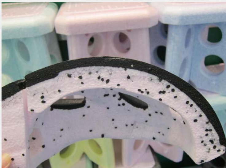
▲巨羚將 EPP 發泡材回收後，使用熱溶法回抽為 PP 塑膠粒，再二次成型為其他塑料用品，材質輕巧安全。圖後方為可承重 200 公斤休閒組合椅。
