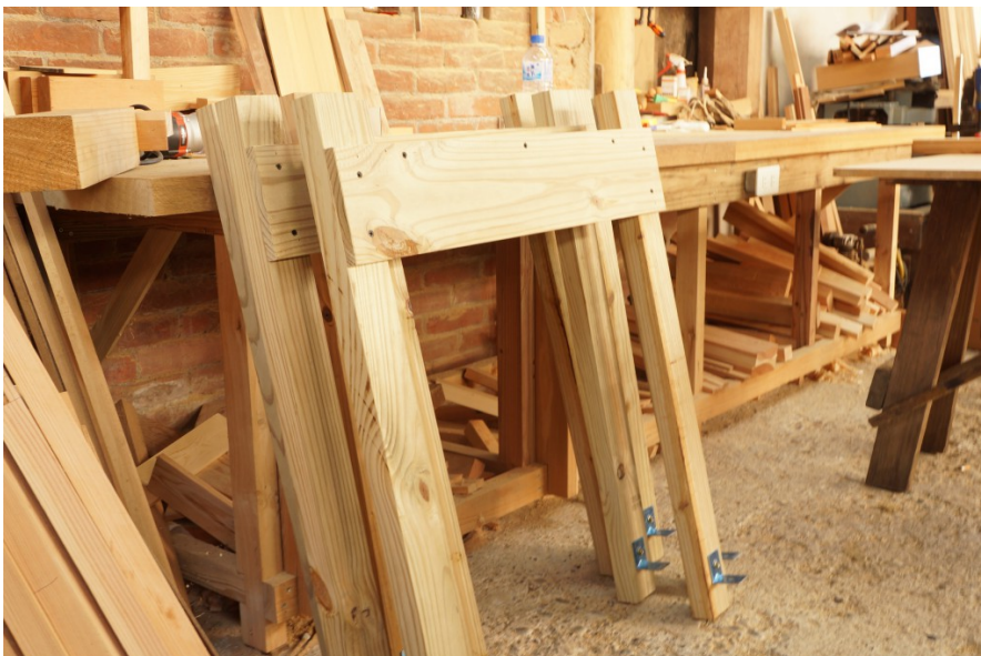
因為要趕時間，一些不是很重要的木器，范振華會直接使用板材廠加工好的木頭。而傳統木工製作，從選材、解木，到防腐處理、精細加工都是木匠一手負責。（照片來源／竇玉帥攝）
