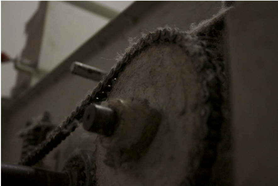
佈滿棉絮的軋棉機，主要用來分離棉籽與棉花，取代了人工開棉、彈棉等步驟，減輕人力負擔。 （照片來源／許人文攝）
