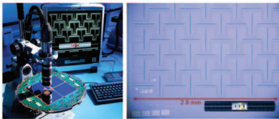
圖 7 左圖：和積體電路類似，以光學蝕刻法大量製造的超導 CMB 偏極偵測器 (影像由 JPL 提供)。過去八年來 JPL 製造了超過 100 片 4 吋矽晶方的偵測器陣列，使 BICEP/Keck 與 SPIDER 團隊在 B 型研究領先世界。右圖：偵測器放大影像可清楚見到兩組互相垂直的微天線 (排成風車圖樣)，區分兩種線性偏極態。此偵測器在 0.25K 的低溫下才能運作。
