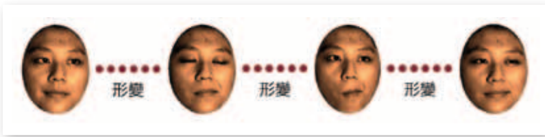
圖 17 3D 影片壓縮構想。真正儲存只有幾幀 3D 圖片，其他在放映時靠形變特效來補足。
