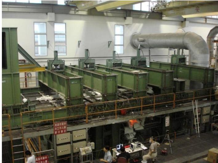
**圖 3-5 防火實驗中心之複合實驗爐**
