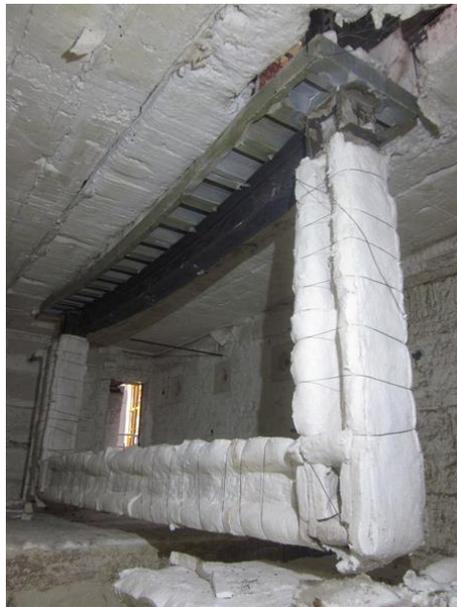
**圖 4-13 試體 C1 耐火試驗後外觀**
