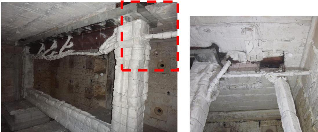
**圖 3-18 柱翼板外側陶瓷棒設置圖**
