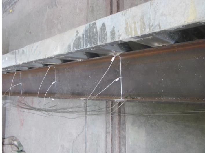
**圖 3-16 受火梁熱電偶配置照片**
