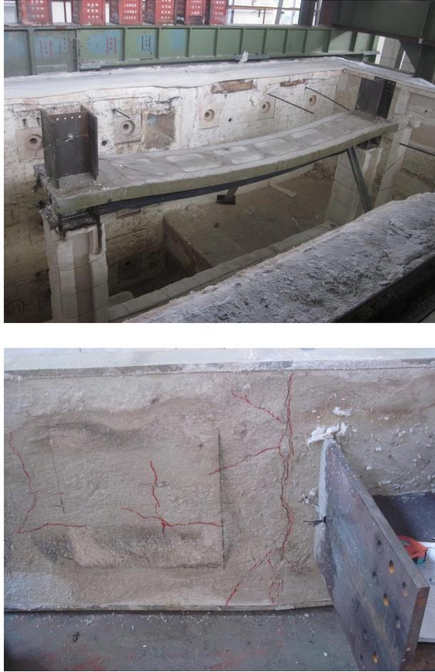
**圖 4-30 試體 C2 樓版裂縫**
