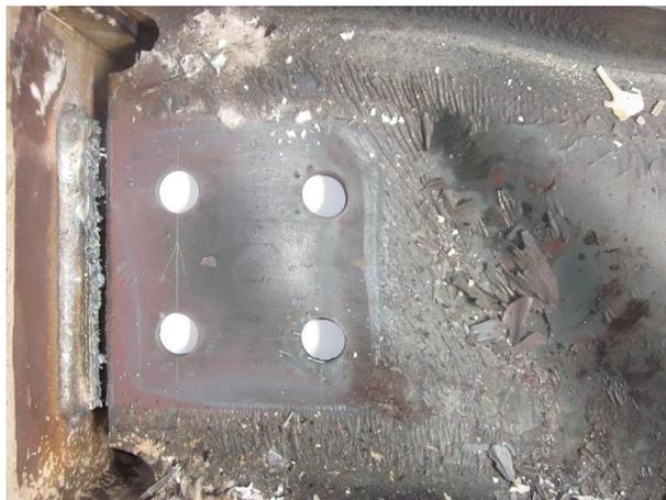
**圖 4-16 試體 C1 螺栓孔變形**
