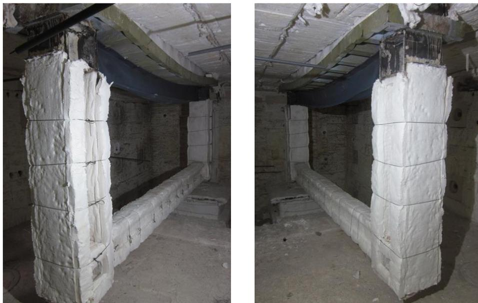
**圖 4-27 試體 C2 耐火試驗後外觀**
