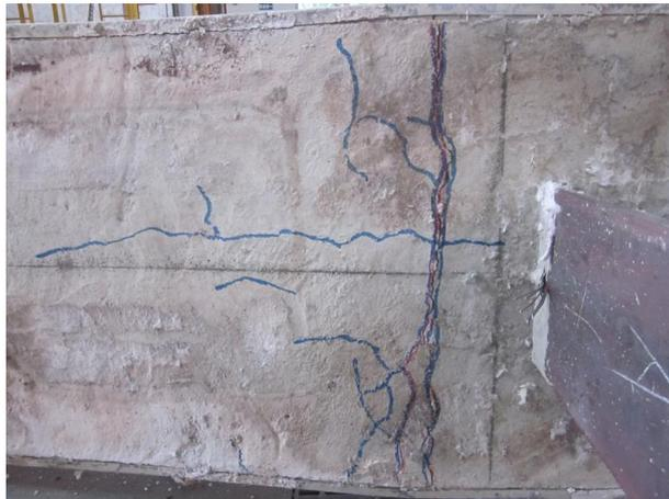
**圖 4-15 試體 C1 樓版裂縫**
