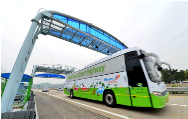
圖為示範車輛通過未來將全面應用的電子收費通道，感應收費時不必再切換車道或減慢車速。（圖片來源/□□□□□）
